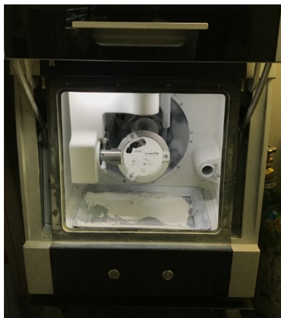
Slika 31. Stavljanje bloka u glodalicu
