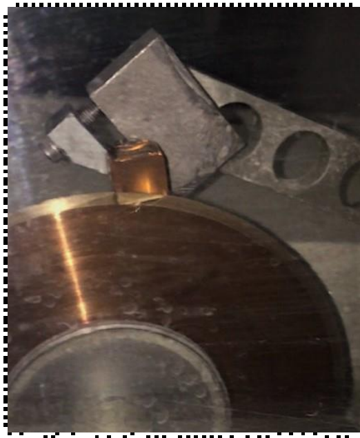
Slika 47. Postupak rezanja CAD/CAM bloka u prekrizaliziranom stanju.
