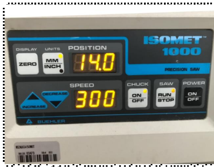
Slika 46. Parametri korišteni za izrezivanje CAD/CAM bloka u diskove.
