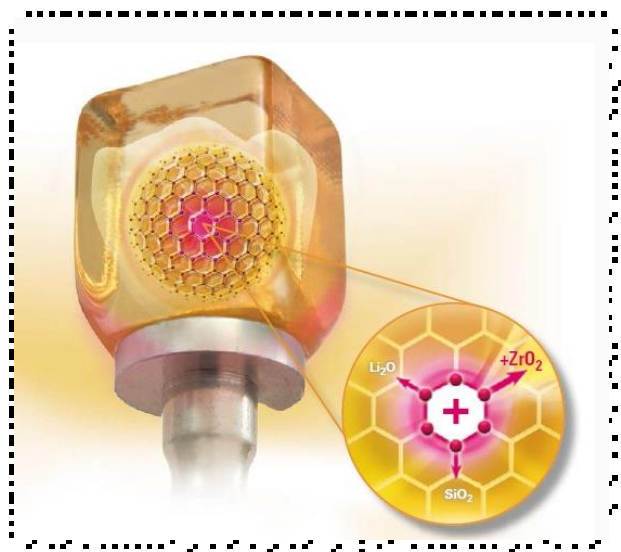
Slika 28. Shematski prikaz sastava litij-disilikatne staklokeramike ojačane cirkonij-dioksidom.
