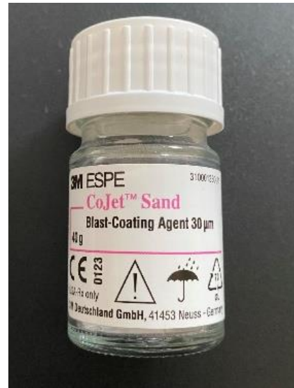
Slika 57. Sredstvo za pjeskarenje uzoraka CoJet Sand.
