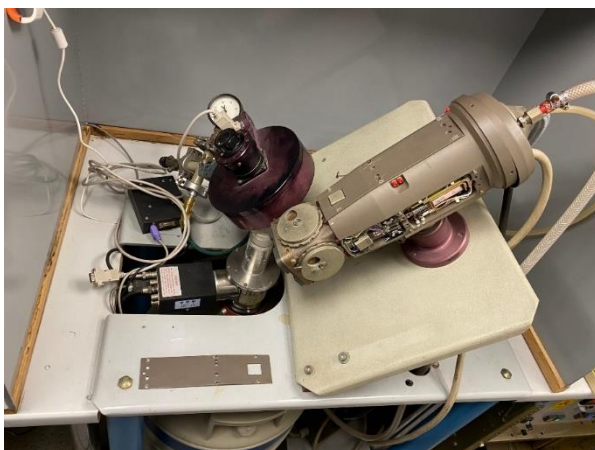
Slika 72 a. Uređaj za EDXRF analizu.
