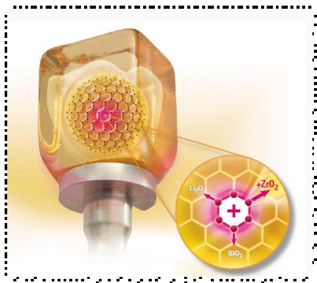
Slika 28. Shematski prikaz sastava litij-disilikatne staklokeramike ojačane cirkonij-dioksidom.
