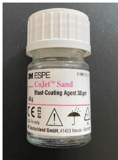
Slika 57. Sredstvo za pjeskarenje uzoraka CoJet Sand.
