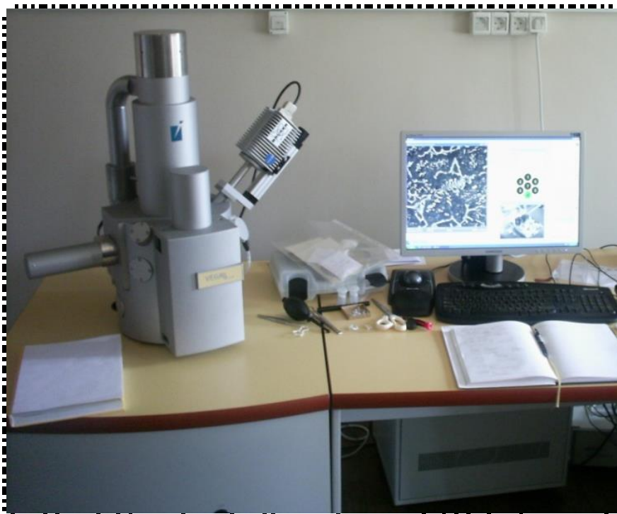
Slika 73. Pretražni mikroskop Tescan Vega TS 5136 MM.
