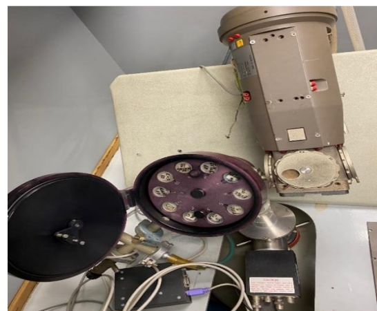
Slika 72 b. Uzorci uloženi u uređaj za EDXRF analizu.
