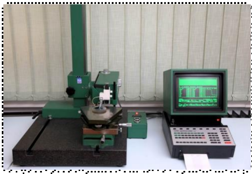
Slika 69. Uređaj za analizu hrapavosti Perthometer S8P.
