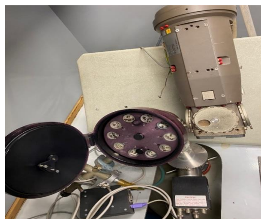
Slika 72 b. Uzorci uloženi u uređaj za EDXRF analizu.
