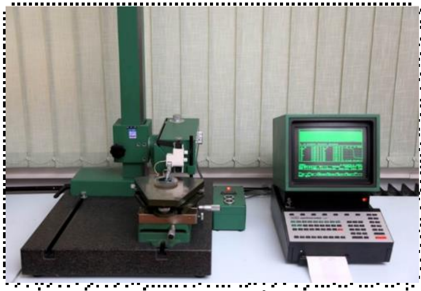
Slika 69. Uređaj za analizu hrapavosti Perthometer S8P.
