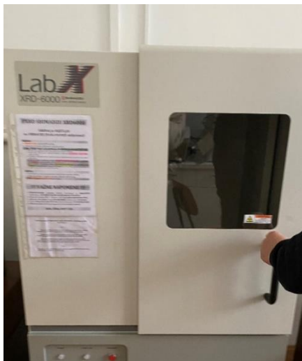
Slika 70. XRD difraktor Shimadzu. XRD-6000.
