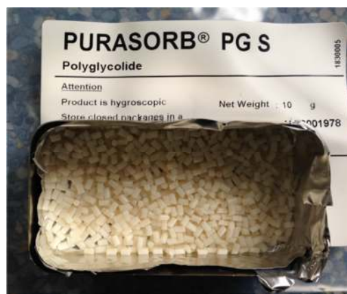
Slika 4. Priprema PG S uzoraka za toplinsku obradu.
