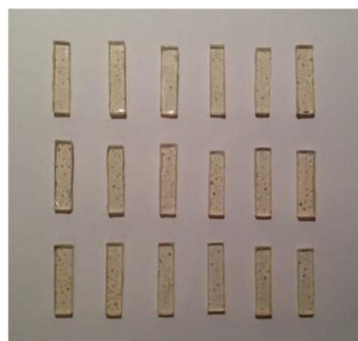
Slika 5.Uzorci PDLG 5010 pripremljeni za uranjanje.
