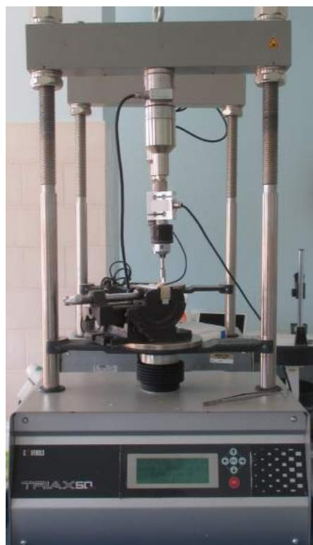
Slika 15. Univerzalni testni uređaj (Triax50, Controls S.P.A., Milano, Italija).
