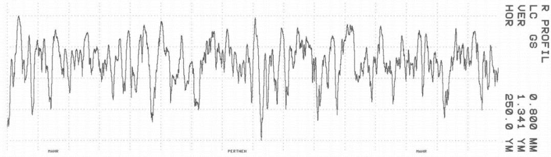
Slika 84. Profil hrapavosti na poliranom uzorku P6.
