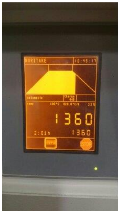
Slika 35. Hlađenje sinteriranih uzoraka u peći.
