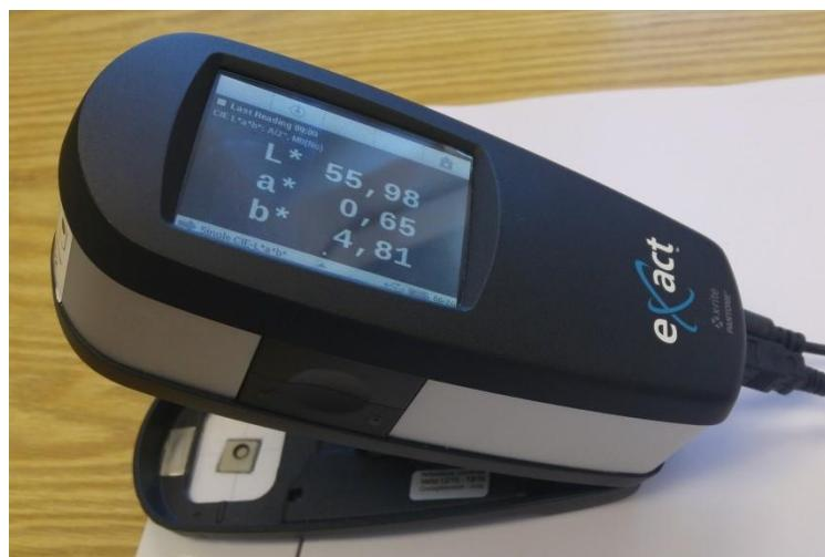
Slika 56. Spektrofotometar X-rite Exact.
