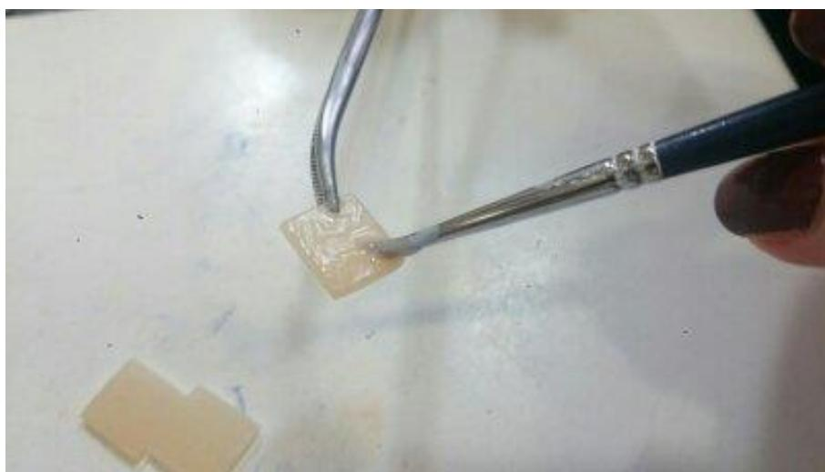
Slika 38. Nanošenje glazure na uzorak.
