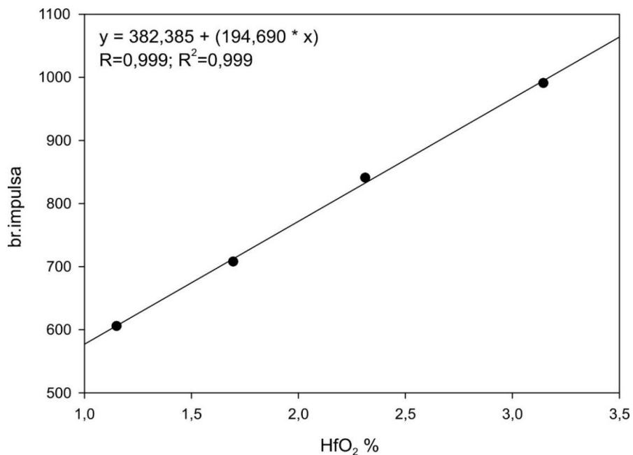
Slika 52. Kalibracijski pravac za  $\text{HfO}_2$ .
