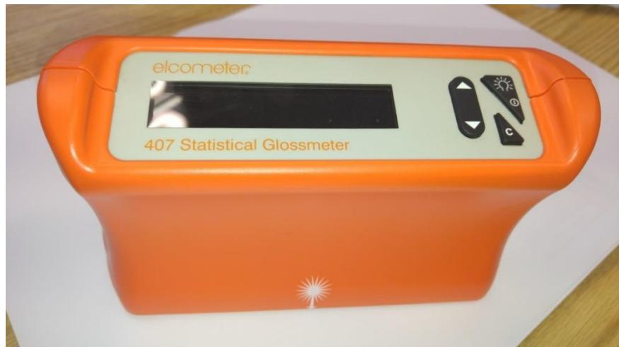
Slika 58. Uređaj za mjerenje sjaja površine Elcometer.
