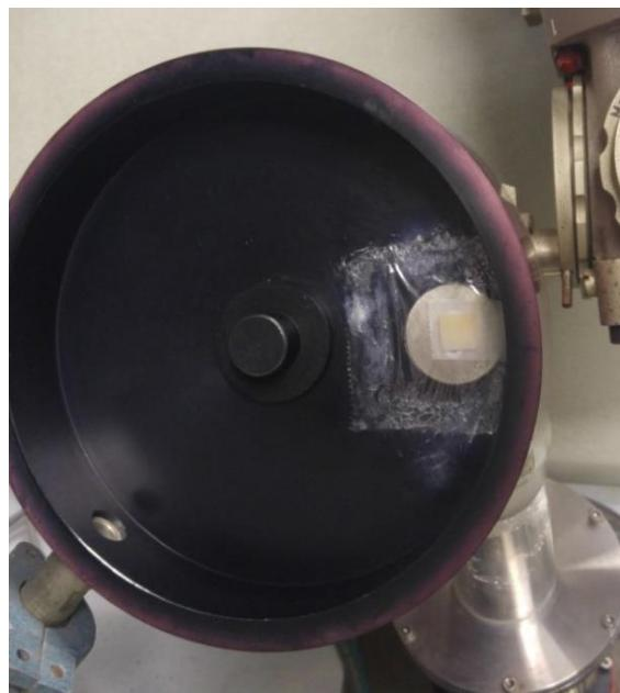
Slika 49. Uzorak pričvršćen na nosaču prozirnom folijom.
