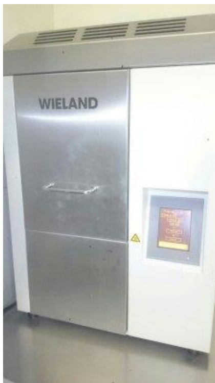
Slika 33. Peć za sinteriranje WIELAND.
