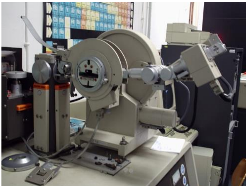
Slika 55. Difraktometar Philips PW 1820.
