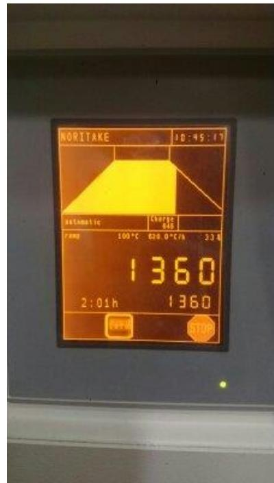
Slika 35. Hlađenje sinteriranih uzoraka u peći.
