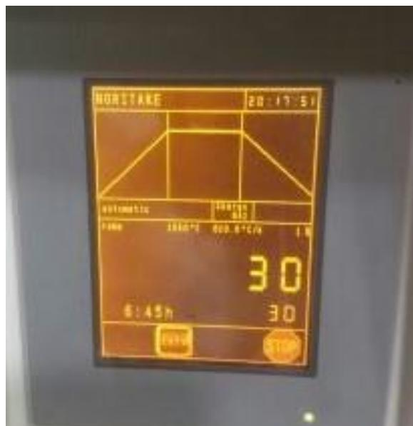
Slika 34. Sinteriranje izglođanih uzoraka prema uputama proizvođača.
