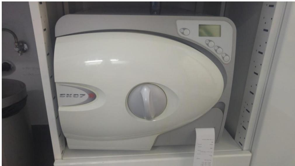
Slika 44. Autoklav korišten za sterilizaciju uzoraka.
