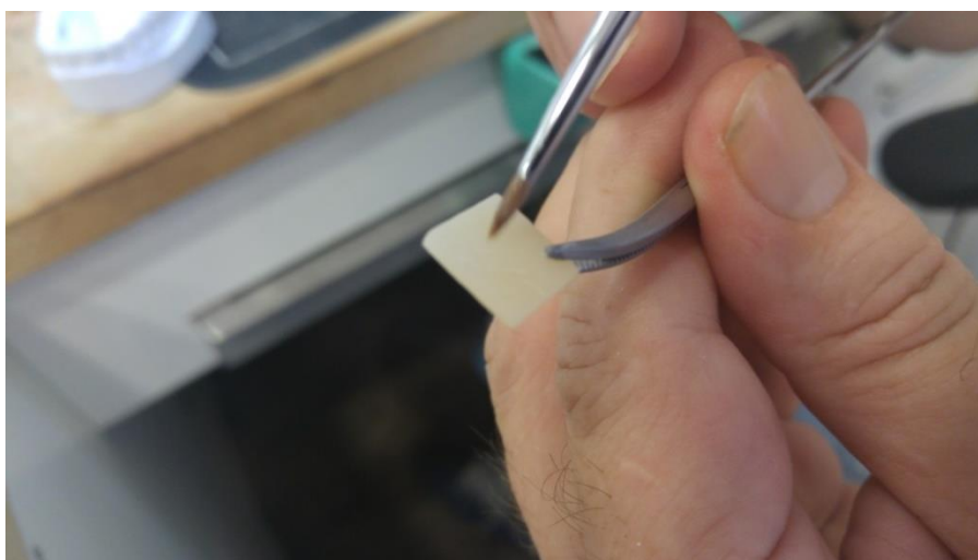
Slika 37. Premazivanje jedne strane uzorka kistom i gelom za glaziranje.
