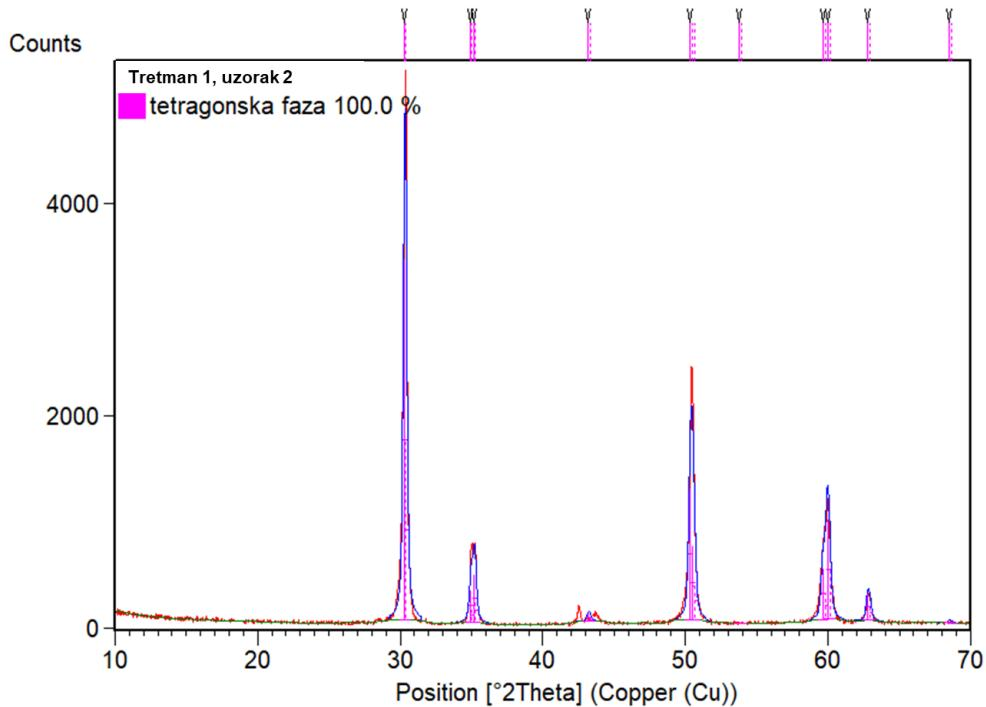
Slika 75. Grafički prikaz rendgenske difraktometrije poliranog uzorka P1 izloženoga hidroermalnoj degradaciji u autoklavu.
