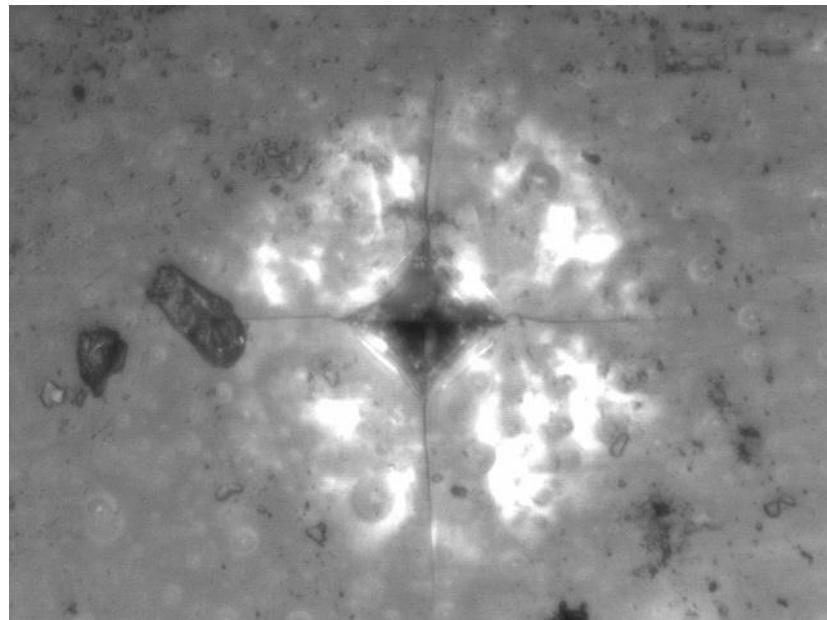
Slika 65. Otisak dijamantne piramide na površini glaziranog uzorka G1 pri opterećenju HV1
