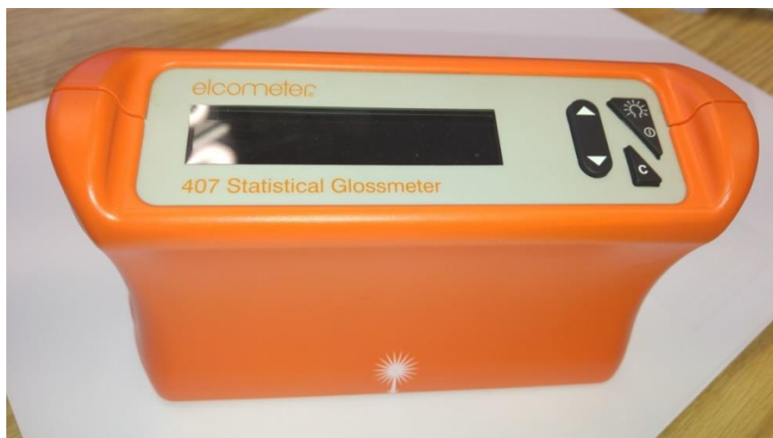
Slika 58. Uređaj za mjerenje sjaja površine Elcometer.
