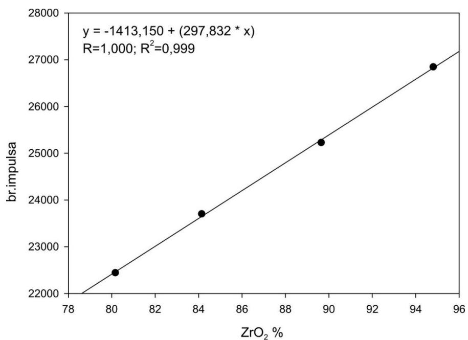
Slika 51. Kalibracijski pravac za  $\text{ZrO}_2$ .
