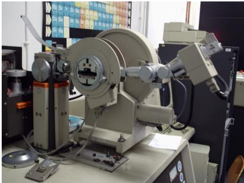
Slika 55. Difraktometar Philips PW 1820.
