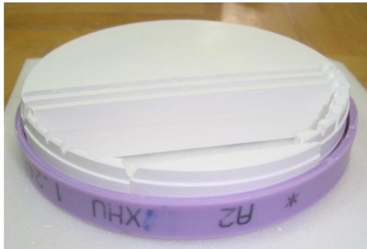
Slika 31. Blok iz kojeg su tehnikom CAD/CAM izglođani uzorci.
