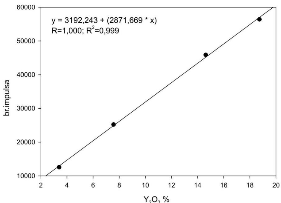
Slika 50. Kalibracijski pravac za  $\text{Y}_2\text{O}_3$ .
