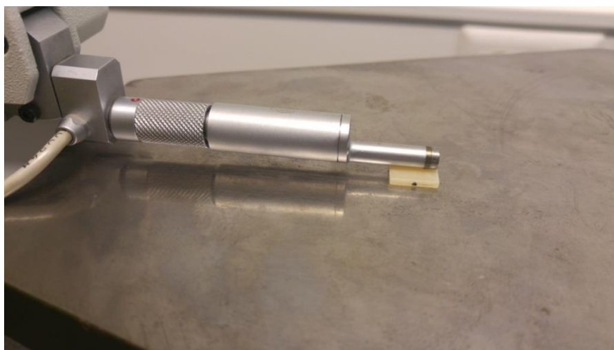
Slika 61. Mjerenje hrapavosti prelaskom ticala uređaja preko površine uzorka.
