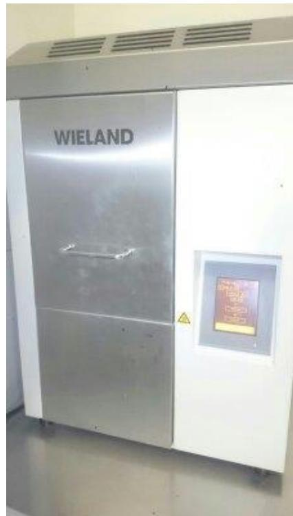
Slika 33. Peć za sinteriranje WIELAND.
