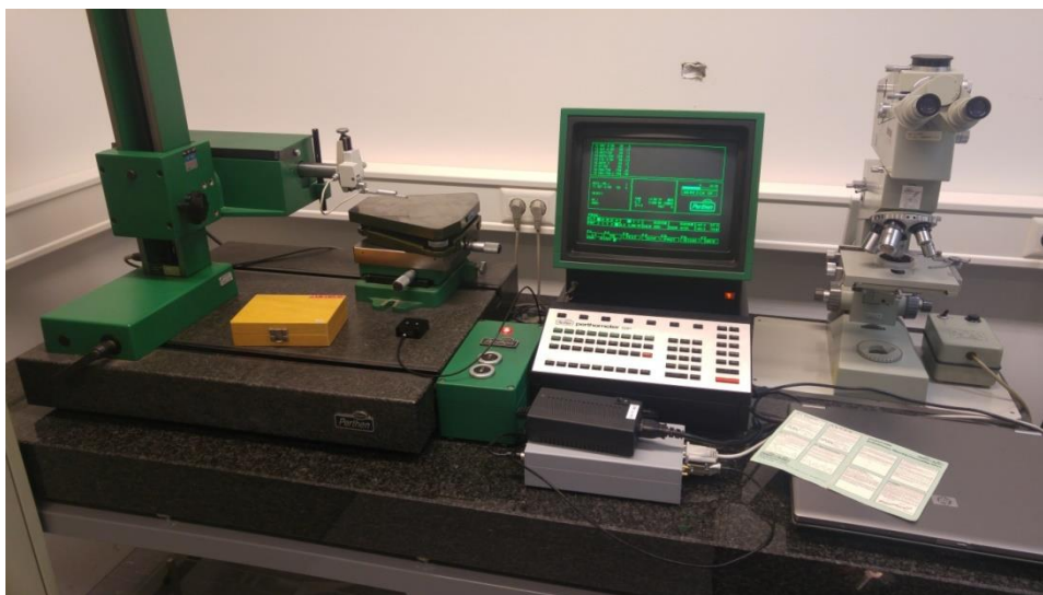
Slika 60. Uređaj za mjerenje površinske hrapavosti – Perthometer S8P.
