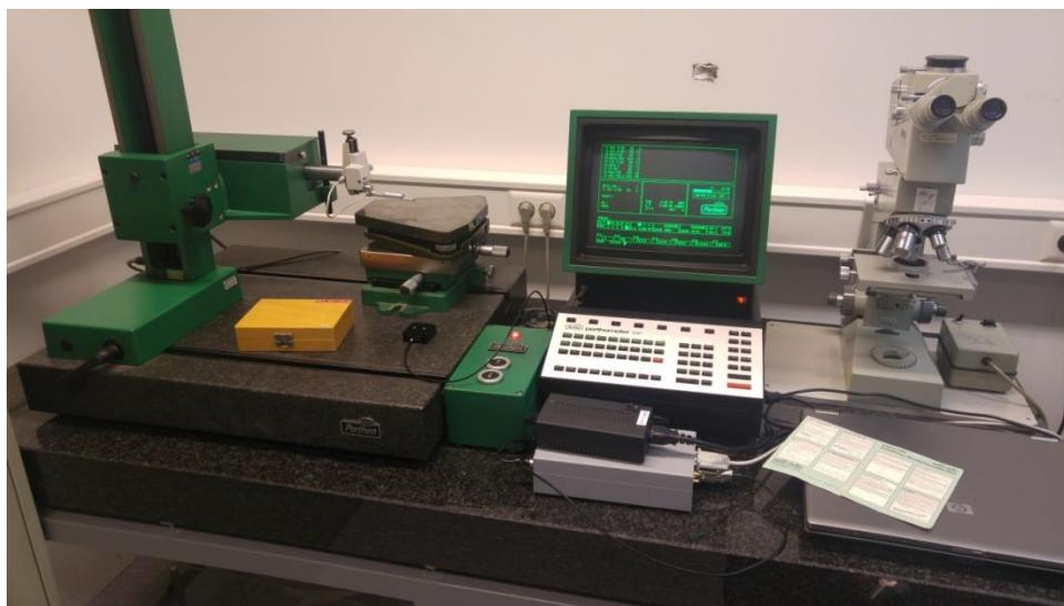
Slika 60. Uređaj za mjerenje površinske hrapavosti – Perthometer S8P.
