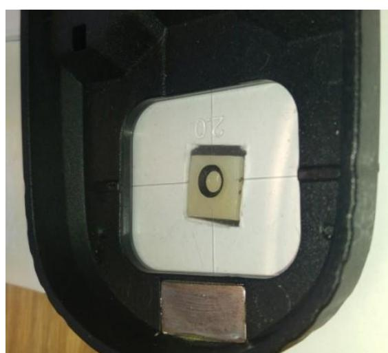
Slika 57. Spektrofotometrija uzorka na crnoj podlozi.
