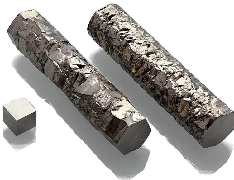
Slika 19. Cirkonij u elementarnom obliku. [Izvorna fotografija preuzeta iz (66). Individualizirao i uredio autor.]
