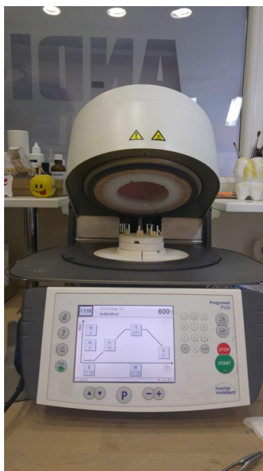
Slika 40. Peć za pečenje glazure - Programat P500.
