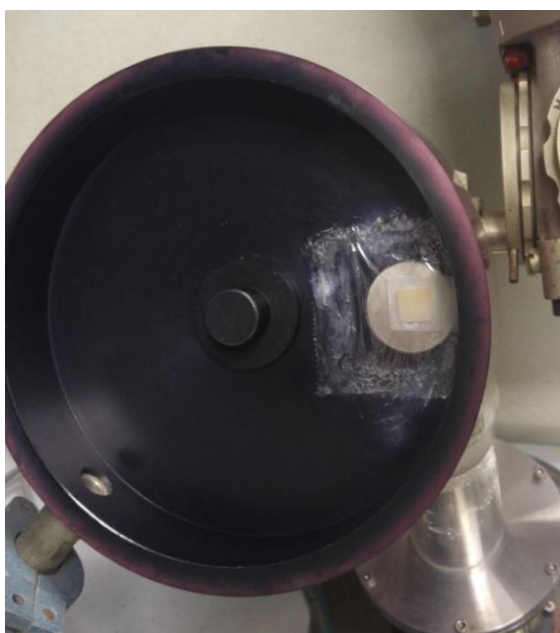
Slika 49. Uzorak pričvršćen na nosaču prozirnom folijom.
