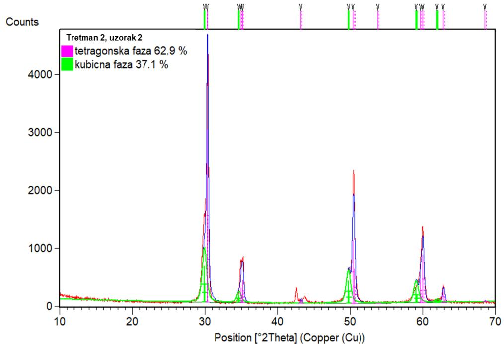
Slika 77. Grafički prikaz rendgenske difraktometrije poliranog uzorka P5 izloženoga kemijskoj degradaciji u korozivnome mediju.
