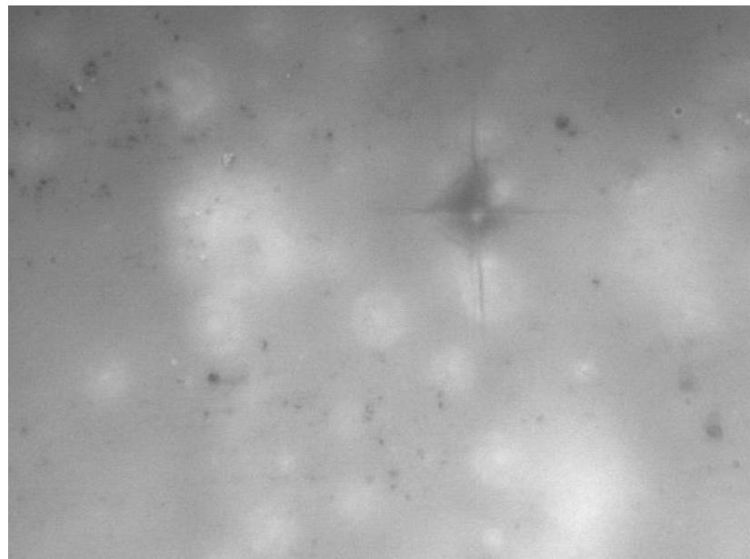
Slika 68. Otisak dijamantne piramide na glaziranom uzorku pri opterećenju HV0.1 – probno mjerjenje. Vidljive su nejasne granice otiska zbog kojih bi mjerjenje dijagonala bilo vrlo teško i neprecizno. Zbog toga su mjerena provedena pri većim opterećenjima.
