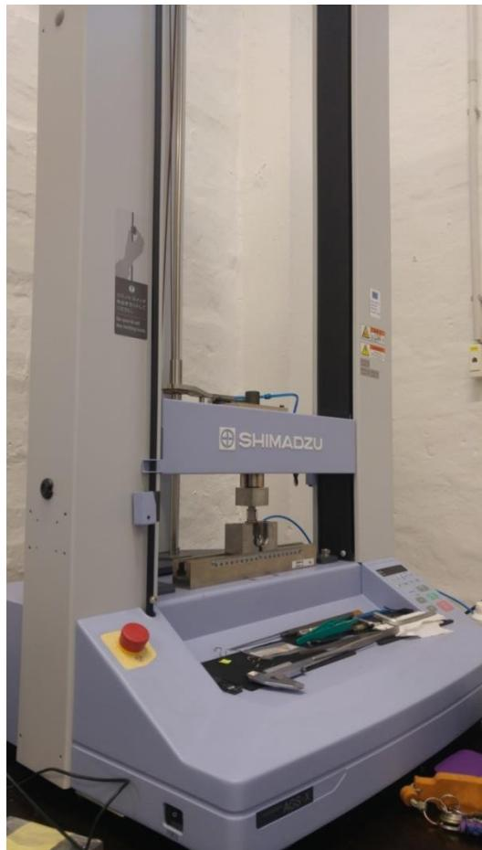
Slika 69. Kidalica Shimadzu AGS-X.
