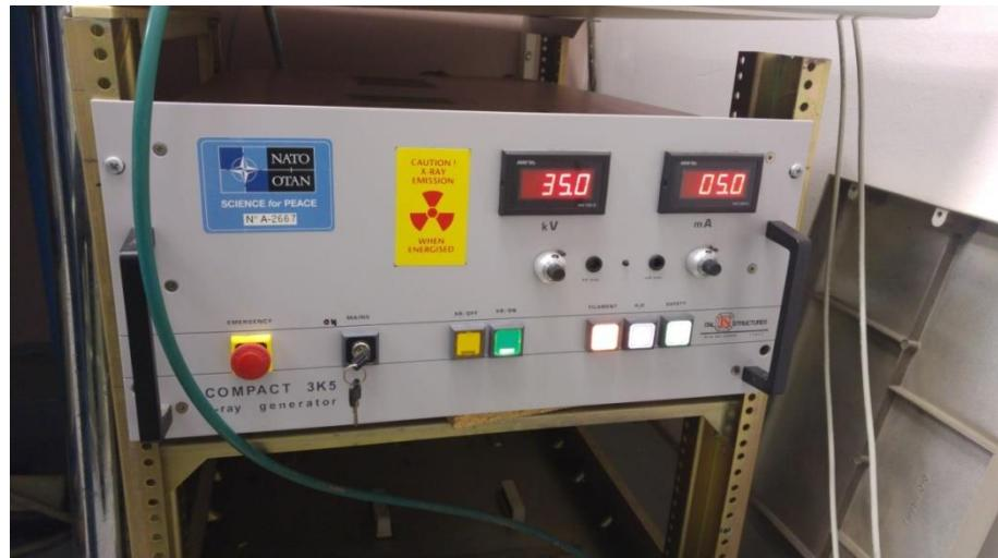
Slika 48. Parametri zračenja: napon 35 kV, jačina struje 5 mA.
