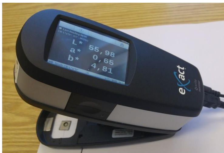
Slika 56. Spektrofotometar X-rite Exact.
