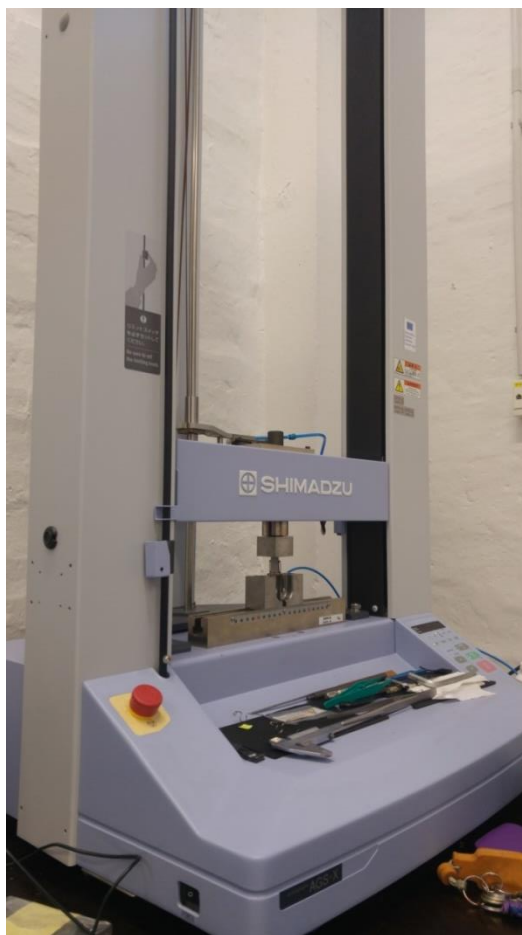
Slika 69. Kidalica Shimadzu AGS-X.
