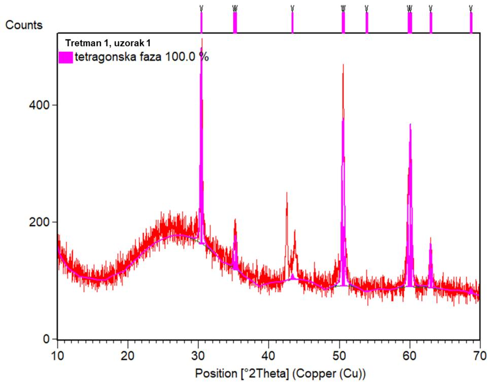
Slika 74. Grafički prikaz rendgenske difraktometrije glaziranog uzorka G1 izloženoga hidroermalnoj degradaciji u autoklavu (crveni pikovi zbog amorfnosti glazure).
