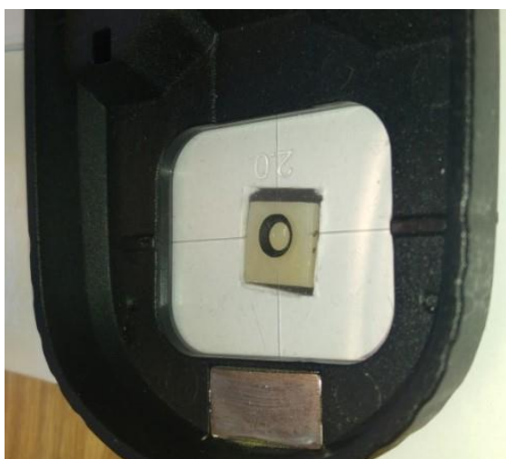
Slika 57. Spektrofotometrija uzorka na crnoj podlozi.
