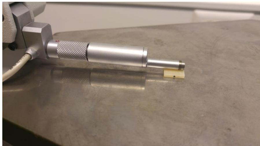
Slika 61. Mjerjenje hrapavosti prelaskom ticala uređaja preko površine uzorka.
