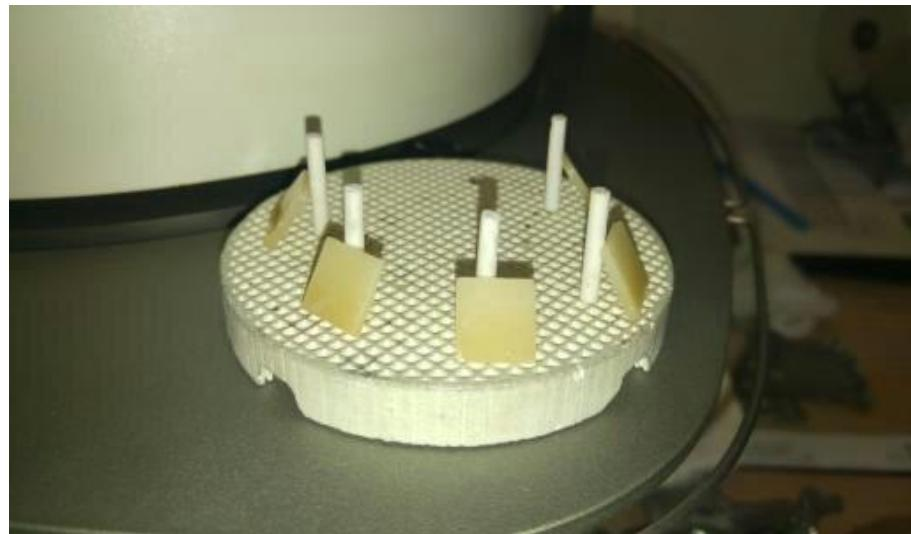
Slika 39. Premazani uzorci glazurom, spremni za završno pečenje.
