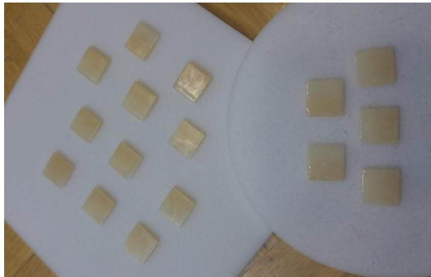
Slika 43. Gotovi polirani uzorci (lijevo) i glazirani uzorci (desno).
