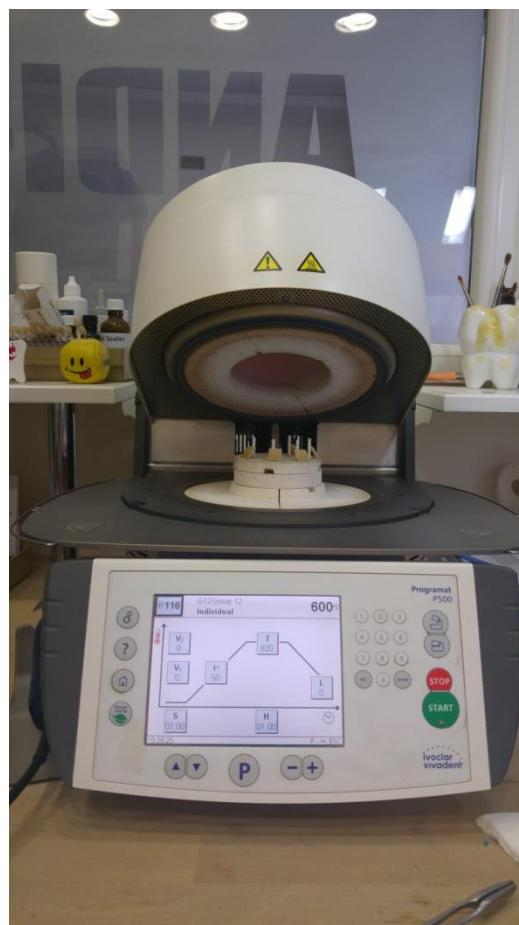
Slika 40. Peć za pečenje glazure - Programmat P500.
