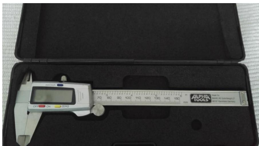
Slika 36. Pomična mjerka za mjerjenje i provjeru dimenzija uzoraka.
