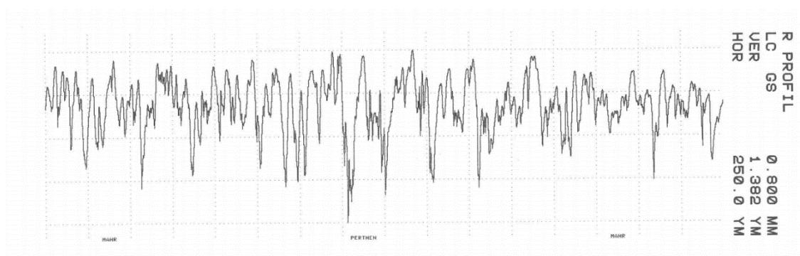
Slika 83. Profil hrapavosti na poliranom uzorku P3.
