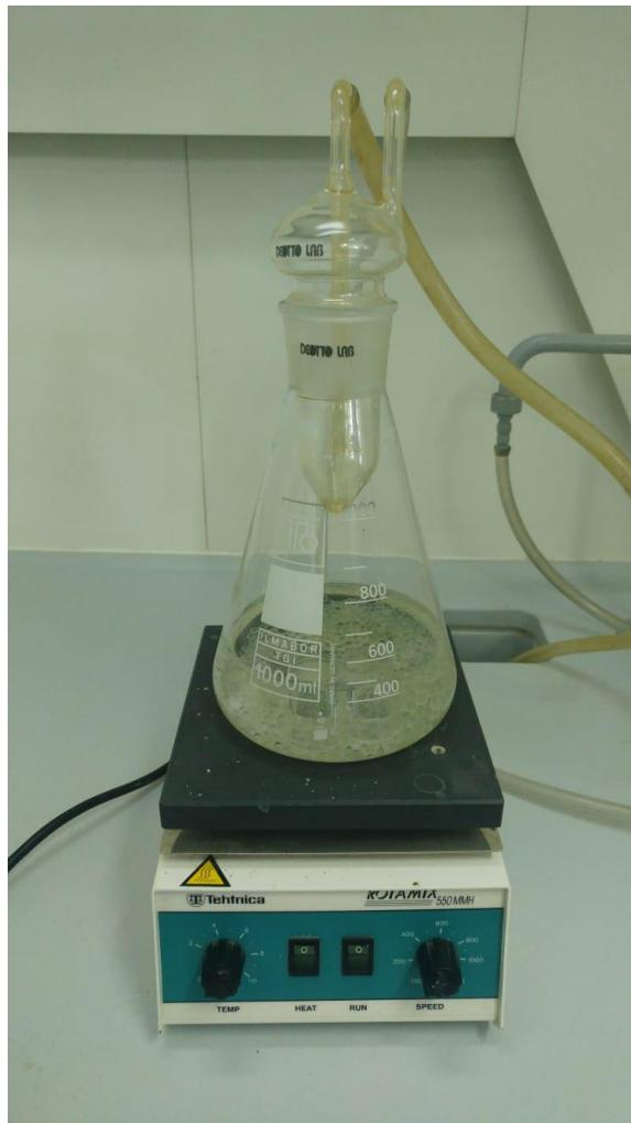
Slika 46. Uzorci uronjeni u korozivni medij.
