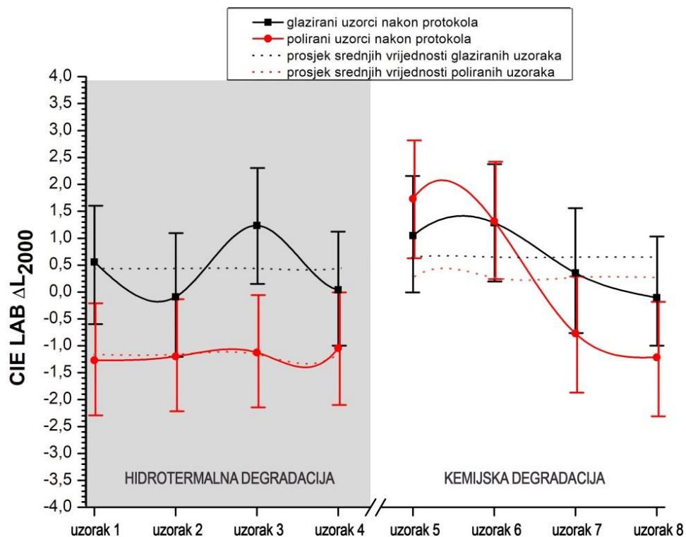
Slika 79. Grafički prikaz intervala vrijednosti  $\Delta L$  ( $AS \pm SD$ ) nakon protokola starenja za glazirane i polirane uzorke.
