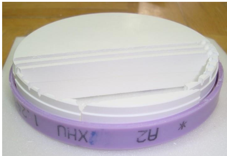
Slika 31. Blok iz kojeg su tehnikom CAD/CAM izglodani uzorci.
