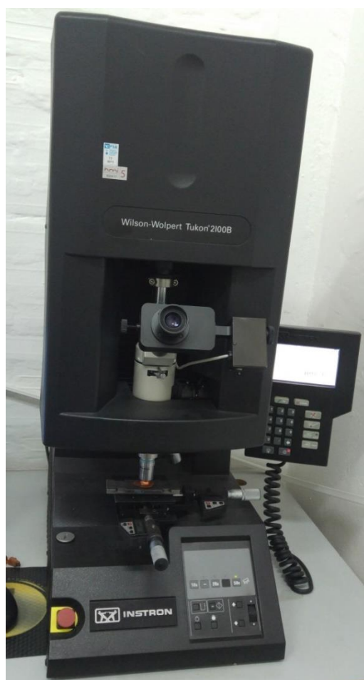
Slika 62. Tvrdomjer Instron Tukon 2100 B za mjerenje tvrdoće materijala.
