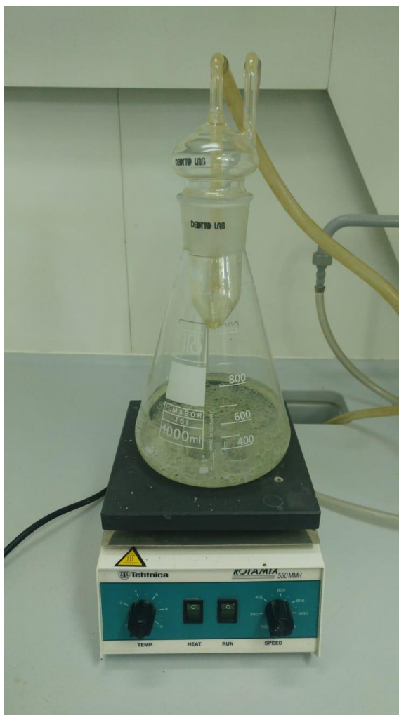
Slika 46. Uzorci uronjeni u korozivni medij.
