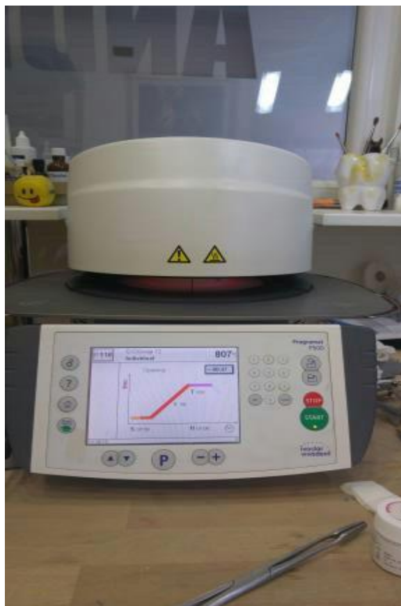
Slika 41. Napečenje glazure prema uputi proizvođača.
