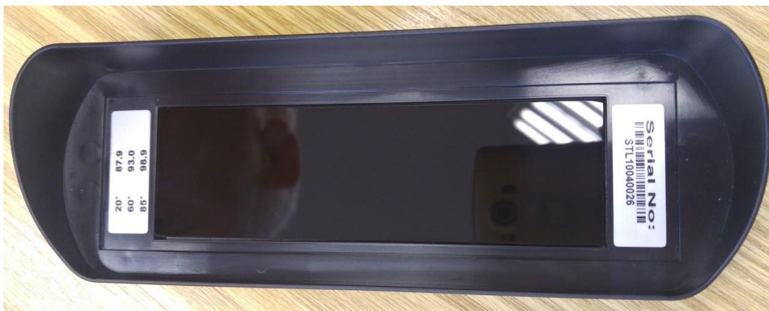
Slika 59. Donja strana glosimetra – sjajna ploča kojom se uređaj kalibrira.
