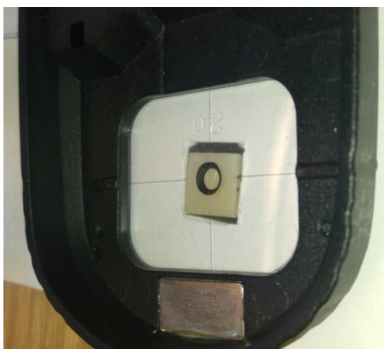
Slika 57. Spektrofotometrija uzorka na crnoj podlozi.
