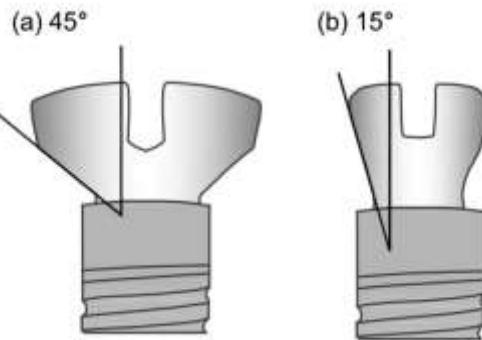
Slika 2. Izgled implantatne nadogradnje s velikim i malim kutom izlaznog profila.
