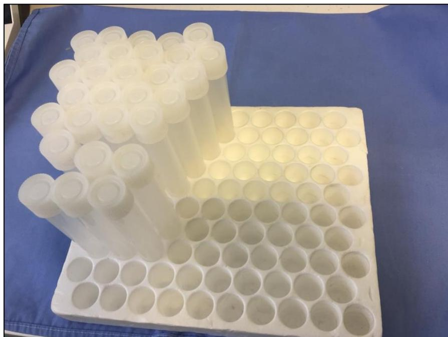
Slika 11. Polipropilenske sterilne epruvete (Kartell, Noviglio, Italija)
