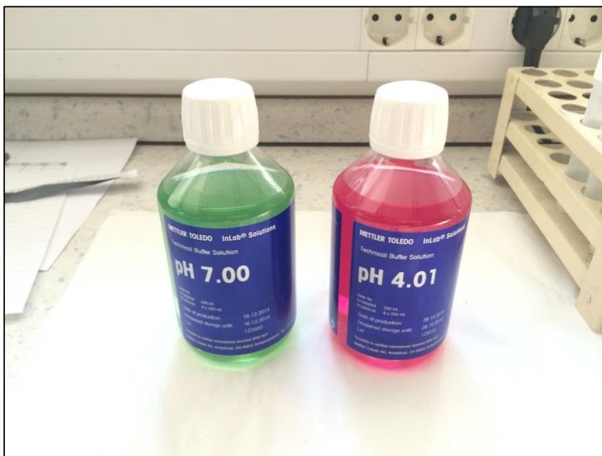
Slika 13. Standardni puferi za kalibraciju pH-metra (Mettler-Toledo, Schwerzenbach, Švicarska)
