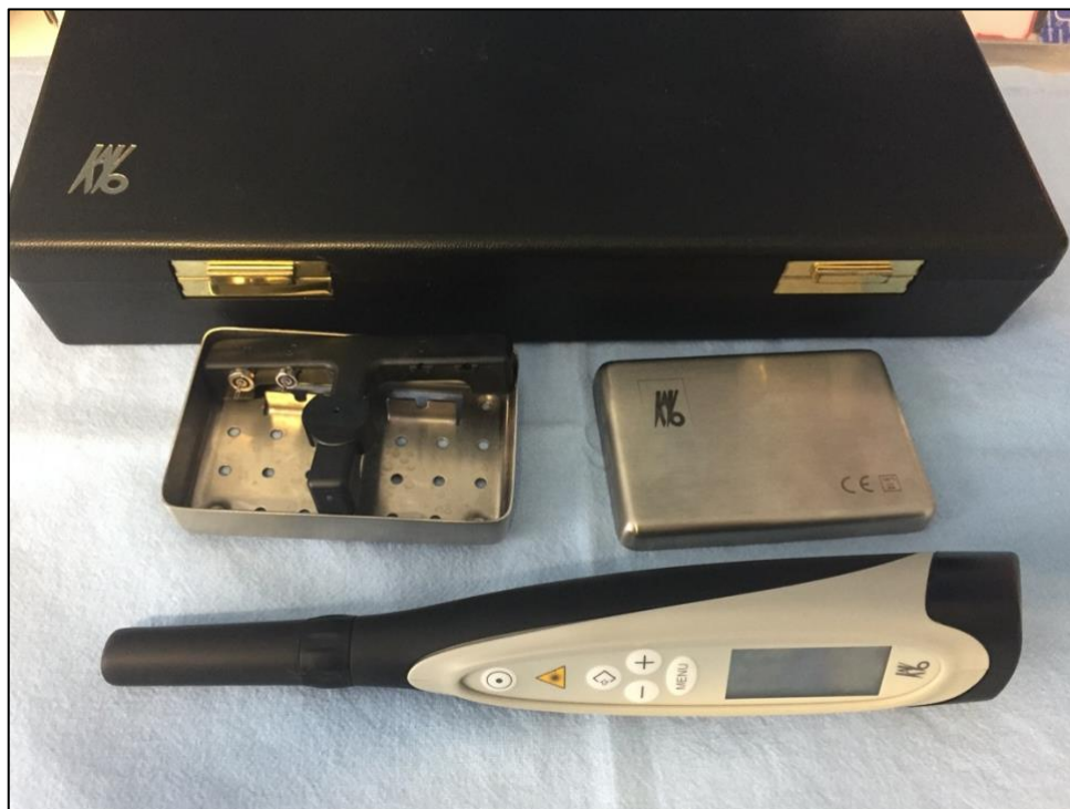
Slika 12. Uređaj KaVo DIAGNOdent Pen i nastavci za svjetlosnu sondu (KaVo America, Lake Zurich, IL)
