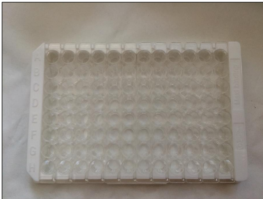
Slika 16. Mikrotitarska pločica s 96 jažica prije početka analize (Enzo Life Science kit, Farmingdale, NY, USA; Cat No. ALX-850-302)
