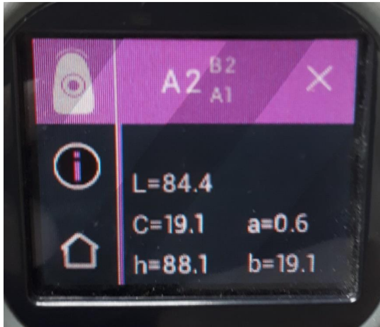
Slika 9. Ekran Vita Easy Shade V spektrofotometra. Na ekranu se očitava boja zuba te L^*a^*b^* vrijednosti
