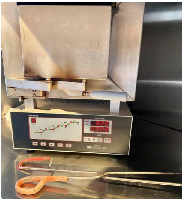
Slika 1. Peć za zagrijavanje.
