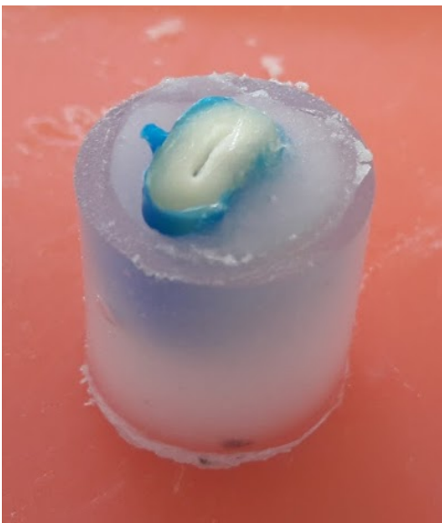
Slika 4. Korijenski dio zuba obavijen poliksilanom uronjen u akrilatni blok.
