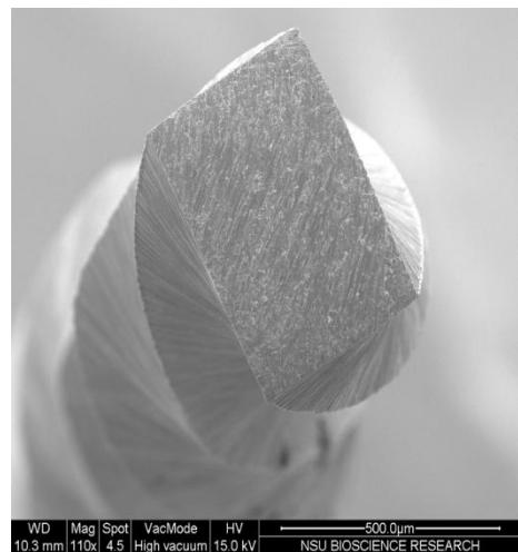
Slika 12 . Pravokutni, poprečni presjek WaveOne Gold instrumenta
