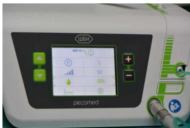
Slika 10. Ultrazvučni uređaj Piezomed, na zaslonu su vidljive postavke koje su odabrane za izradu retrogradnih kaviteta.
