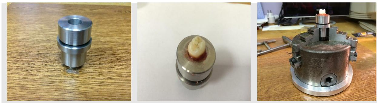
Slika 28. Nosač uzorka fiksiran u elementu za prihvatanje nosača uzorka
