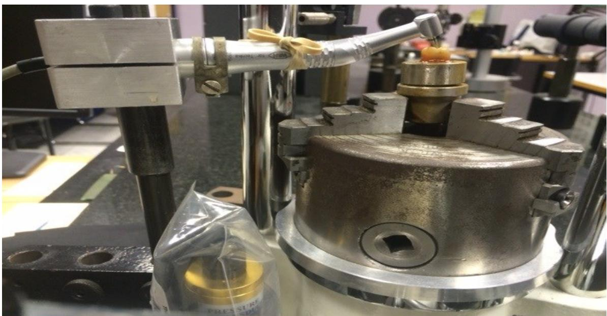
Slika 30. Fiksirani mirkomotor sa svrdlom, koji je postavljen duž prednje stijenke kaviteta
