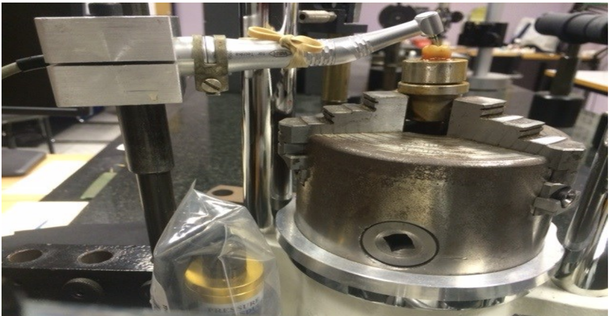
Slika 30. Fiksirani mikromotor sa svrdlom, koji je postavljen duž prednje stijenke kaviteta
