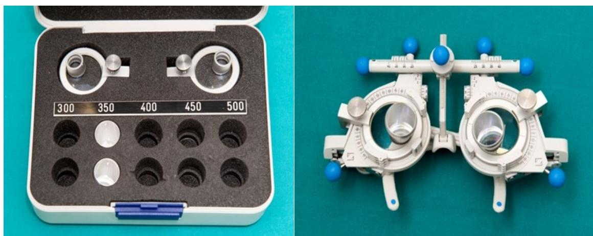
Slika 20. Galilejev teleskop GTX, 2,5x, 350 mm, montiran na plano leću u probnim okvirima
