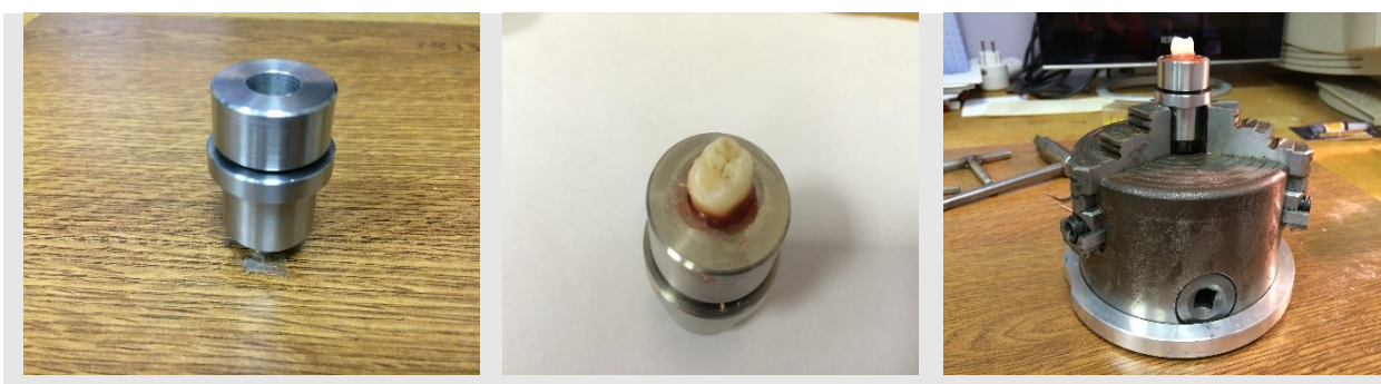
Slika 28. Nosač uzorka fiksiran u elementu za prihvat nosača uzorka
