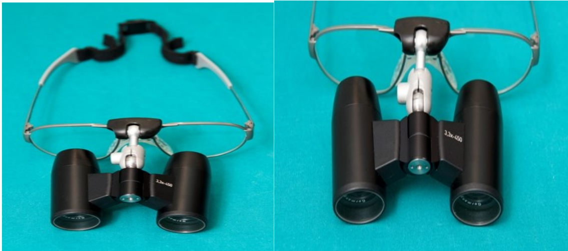
Slika 21. Keplerov teleskop KF, 3,3x, 450 mm
