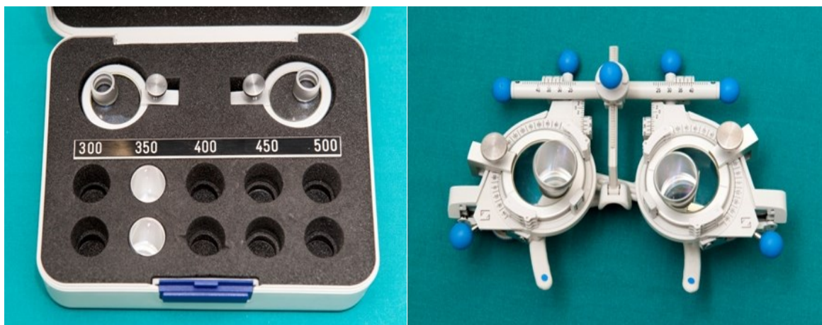
Slika 20. Galilejev teleskop GTX, 2,5x, 350 mm, montiran na plano leću u probnim okvirima
