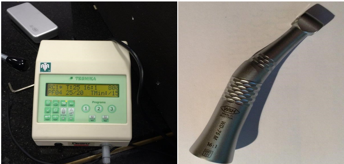
Slika 24. Instrument za strojnu preparaciju kaviteta (Maillefer NiTi system, Dentsplay Tecnika Ballaigue, Switzerland) s mikromotorom 16:1 okretni moment (WD-75 M, W&H Dentalwerk Bürmoos GmbH, Bürmoos, Austria)
