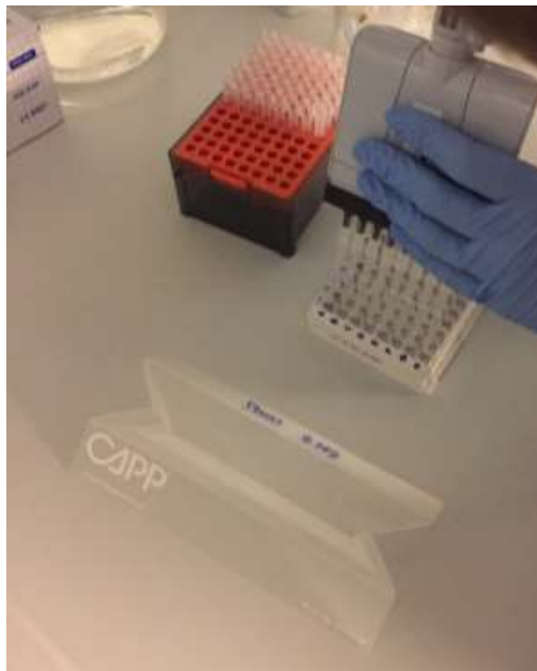
Slika 16. Prikaz pipetiranja uzoraka pomoću multikanalne pipete u ELISA pločicu
