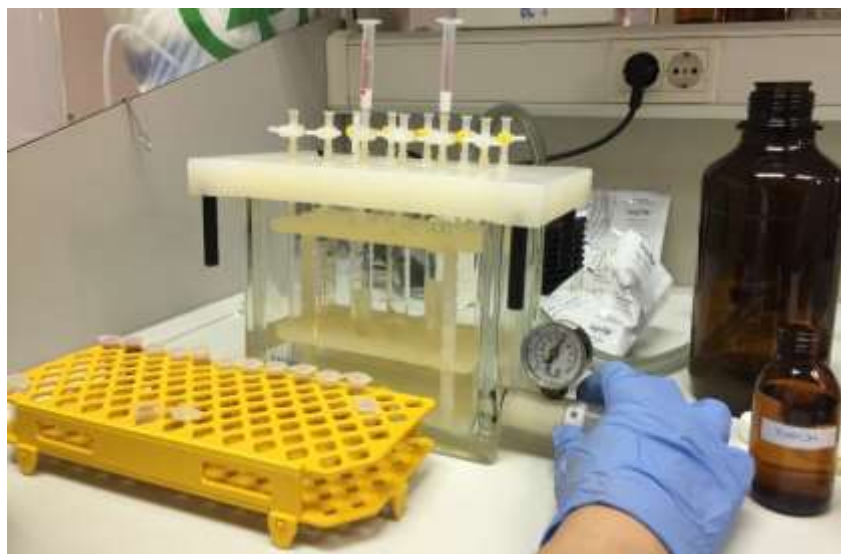
Slika 15. Kondicioniranje kolonica za ekstrakciju na SPE vakuum Manifold instrumentu ( Restek™ Resprep 12-Port Tube Manifold, Restek, Bellefonte, USA )
