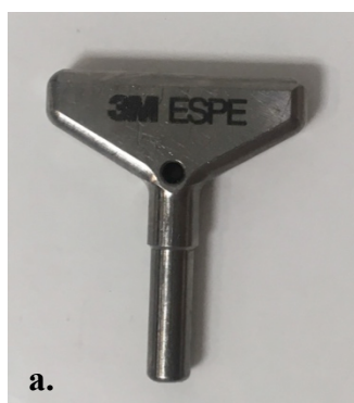
Slika 24. Leptir-ključ (a.) i moment-ključ (b.) za ugradnju mini dentalnih implantata
