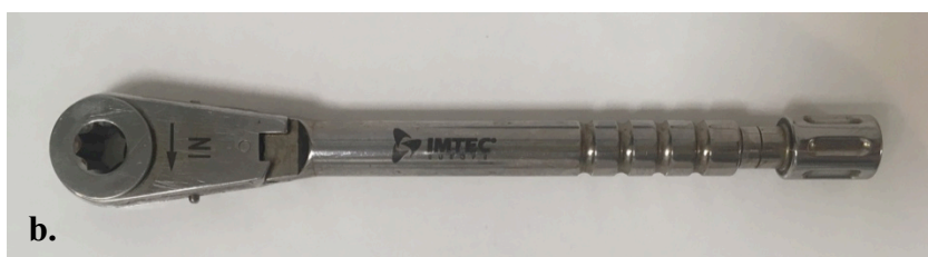
Slika 24. Leptir-ključ (a.) i moment-ključ (b.) za ugradnju mini dentalnih implantata
