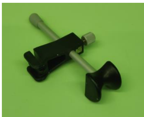
Slika 19. Nastavak za nasion
