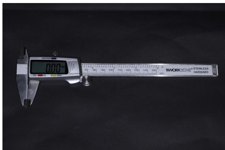
Slika 4. Digitalna pomična mjerka
