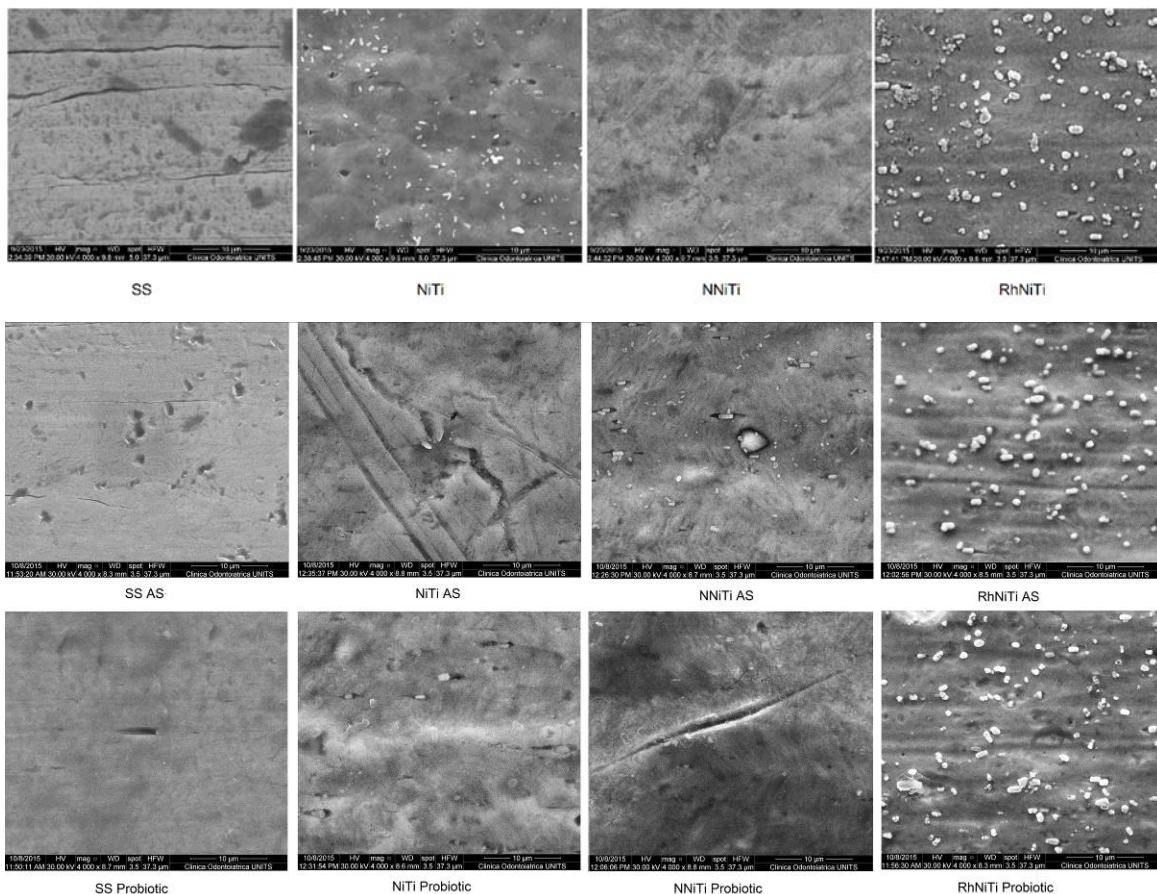
Slika 30. SEM povećanje 4.000 puta neeksponirane (prvi red), nakon izlaganja umjetnoj salini (drugi red) te nakon umjetne sline i probiotičkog pripravka *BioGaia* (treći red).
