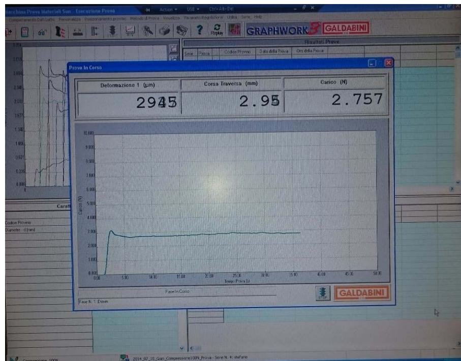
Slika 11. Mjerenje trenja univerzalnim strojem za ispitivanje materijala Sun 500
