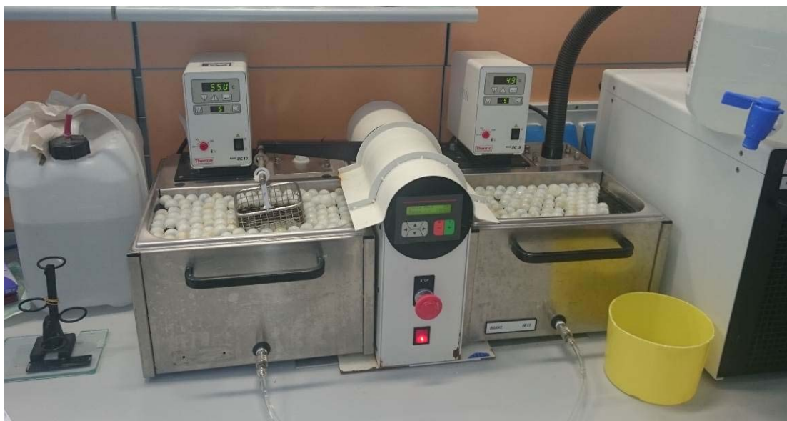
Slika 3. Uređaj za termocikliranje ( Thermo Haake Willytech , SD Mechatronik Feldkirchen-Westerham, Njemačka)
