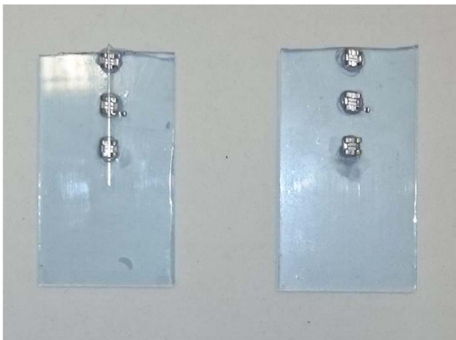
Slika 12. Simulacija fiksne ortodontske naprave za mjerenje trenja
