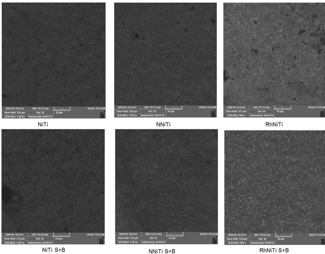
Slika 24. SEM povećanje 1.000 puta neekspozirane (prvi red) te nakon elektrokemijskih testiranja u slini s dodatkom probiotičkog pripravka *BioGaia* (drugi red).
