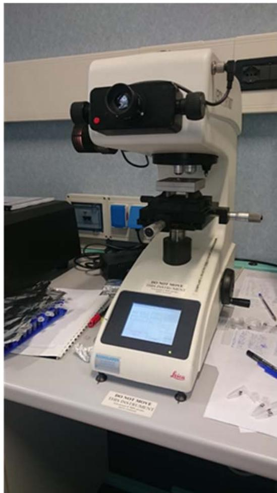
Slika 9. Uredaj za mjerjenje mikrotvrdoće Leica VMHT MOT
