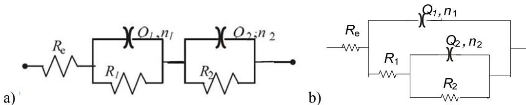
Slika 21. a) električni ekvivalentni krug za čeličnu i rodiniranu žicu u svim medijima te sve žice u slini s probiotičkim pripravkom; b) električni ekvivalentni krug za nitiriranu NiTi nakon 28 dana u slini ili slini s *L. reuteri* bakterijama.
