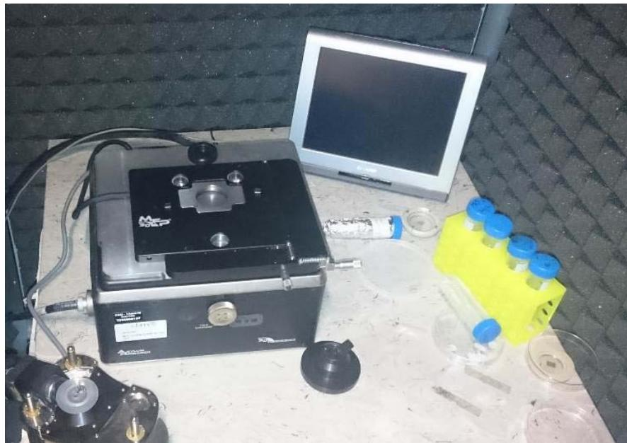
Slika 7. Mikroskop atomskih sila (AFM) NT-MDT Solver Pro AFM
