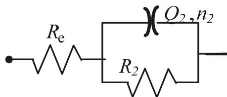
Slika 20. Električni ekvivalentni krug za neobloženu žicu u čistoj slini u svim medijima osim slini s probiotičkim pripravkom te nitriranu NiTi nakon 2 sata u slini.
