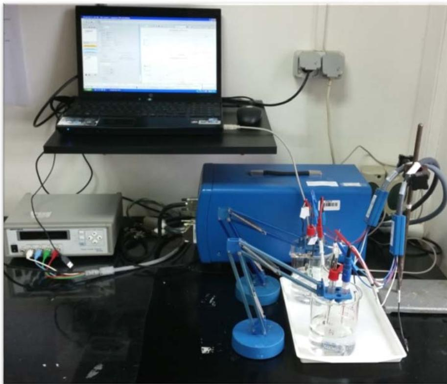
Slika 13. Potenciostat za elektrokemijska mjerena korozije EIS Biologic SP-300
