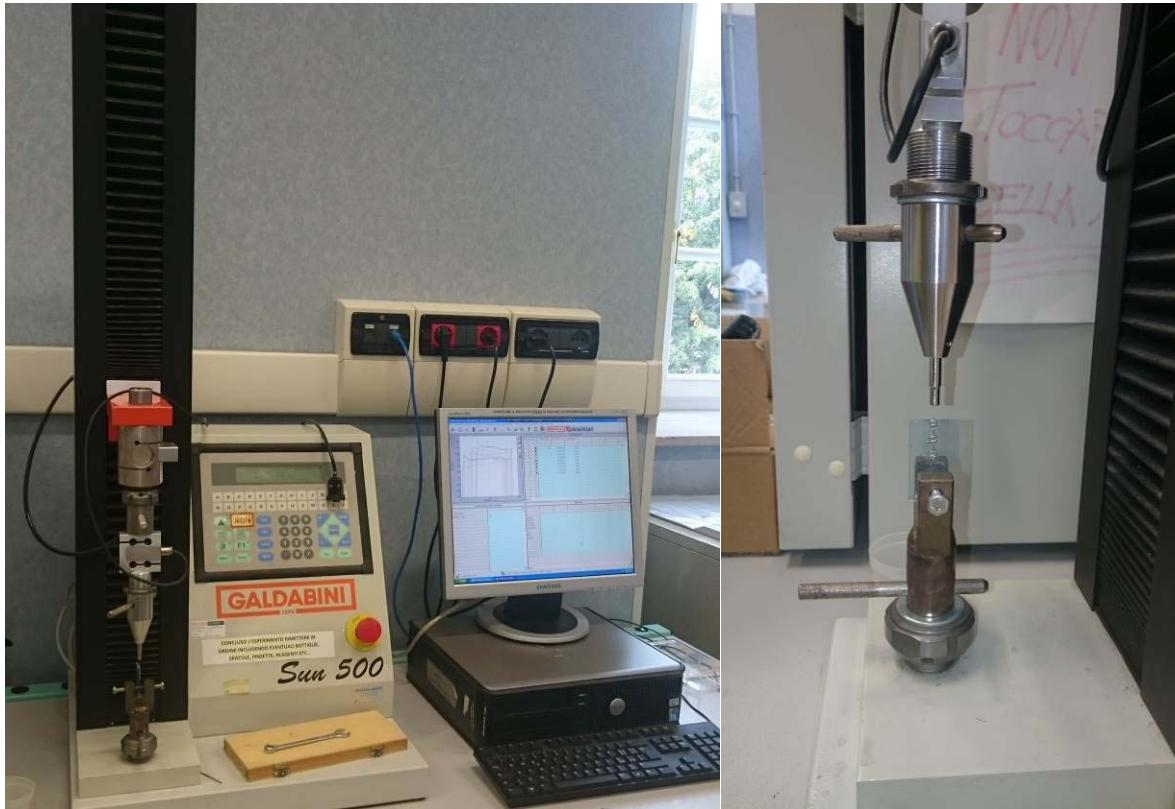
Slika 10. Mjerenje trenja univerzalnim strojem za ispitivanje materijala Sun 500
