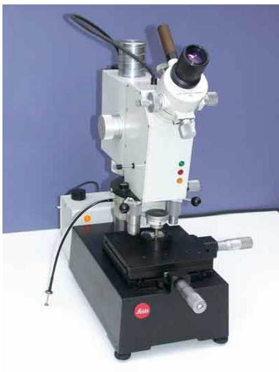
Slika 5. Uređaj za ispitivanje mikrotvrdoće Leitz Miniload 2 (Leitz, Oberkochen, Njemačka).
