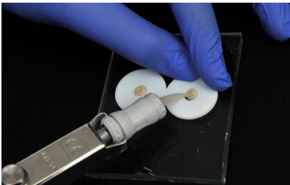
Slika 4. Istiskivanje zamiješanog materijala iz kapsule u teflonski kalup na staklenoj podlozi
