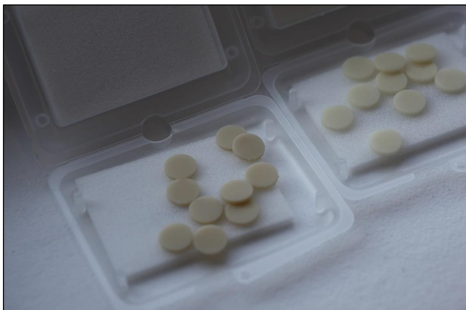
Slika 3. MMA uzorci izrađeni tehnologijom 3D printanja
