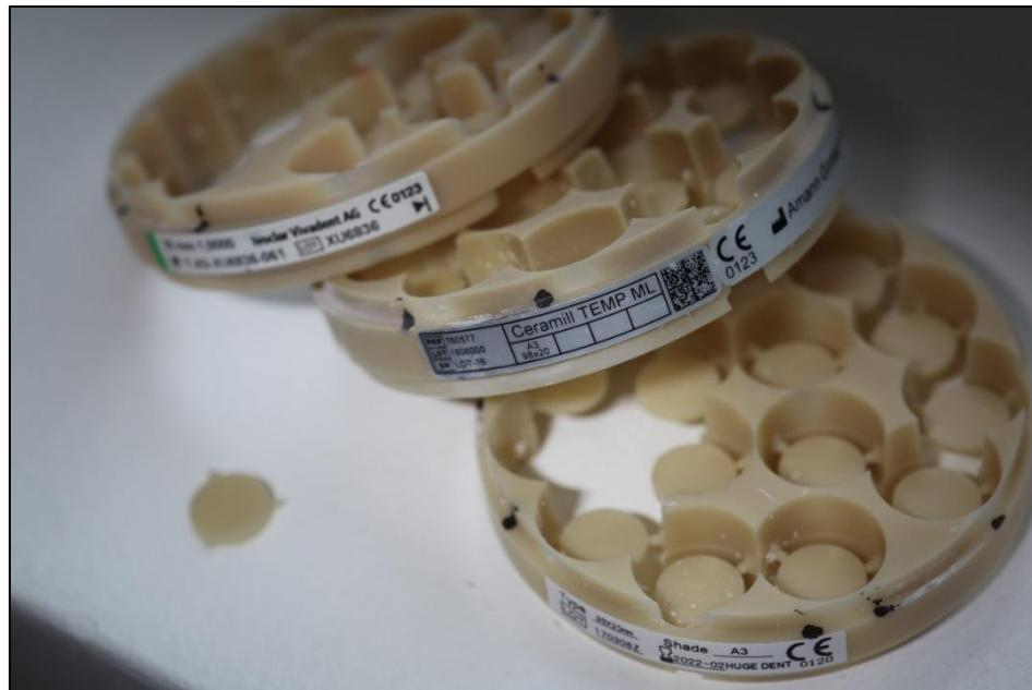
Slika 2. Uzorci izrađeni CAD/CAM tehnologijom neposredno nakon glodanja
