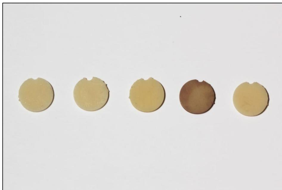
Slika 5. Uzorci od 3D printanog materijala Nextdent C&B (Nextdent, Soesterberg, Nizozemska) nakon 30 dana pohranjivanja u (s lijeva na desno): 1) destiliranoj vodi, 2) Coca-Cola, 3) kavi, 4) crnom vinu i 5) balzamičnom octu
