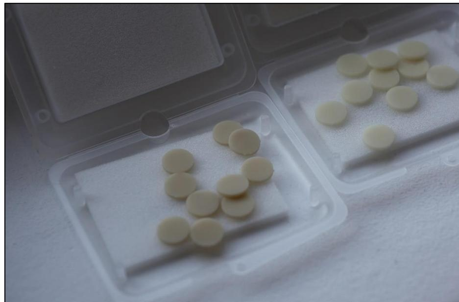
Slika 3. MMA uzorci izrađeni tehnologijom 3D printanja
