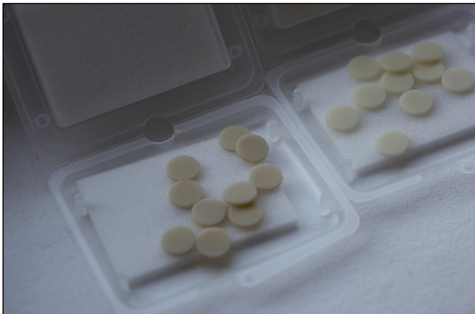
Slika 3. MMA uzorci izrađeni tehnologijom 3D printanja
