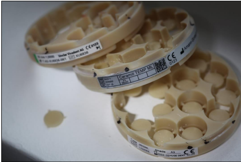
Slika 2. Uzorci izrađeni CAD/CAM tehnologijom neposredno nakon glodanja
