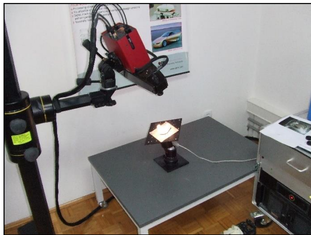
Slika 9. Snimanje modela ATOS II SO sustavom. Preuzeto s dopuštanjem autora: Martine Šlaj.
