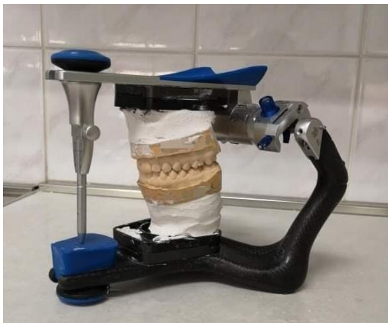
Slika 12. Modeli gornje i donje čeljusti sadrom učvršćeni i pozicionirani u artikulator.
