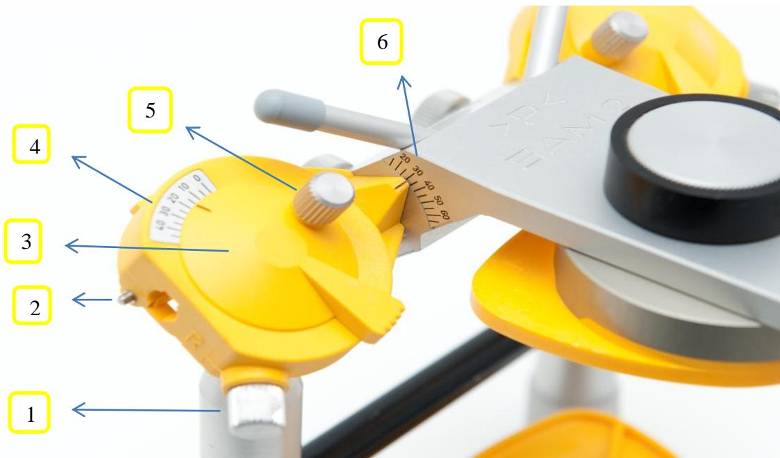
Slika 14. Mehanički zglob artikulatora.
