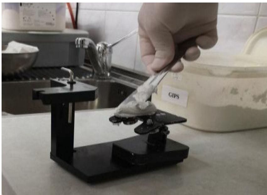
Slika 8. Nanošenje sadre na prijenosno postolje.
