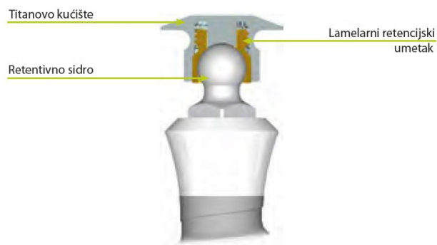
Slika 16. Matrica i retencijski umetak u funkciji. (preuzeto i prilagođeno iz 58)
