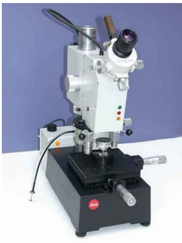
Slika 11. Uređaj Leitz Miniload 2 Microhardness Tester
