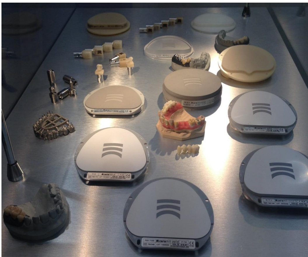
Slika 12. Protetski nadomjestci izrađeni CAD/CAM-om. Preuzeto s dopuštenjem autora: doc. dr. sc. Andreja Carek.
