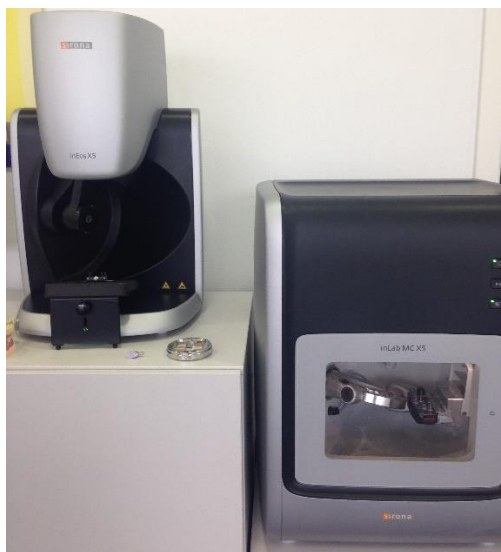
Slika 6. Glodalica za laboratorijski sustav izrade i InEos X5 uređaj. Preuzeto s dopuštenjem autora: doc. dr. sc. Andreja Carek.
