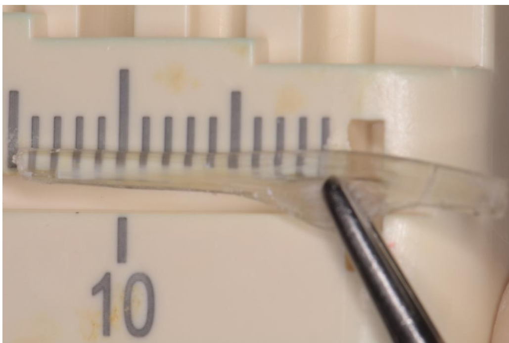
Slika 14. Mjerenje potrebne duljine everStick kolčića
