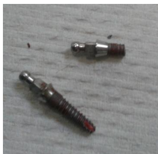
Slika 18. Puknuti mini dentalni implantat; preuzeto s dopuštenjem autora: doc. dr. sc. Peršić Kiršić
