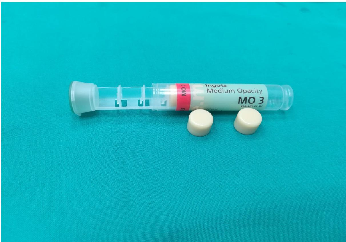
Slika 1. Keramički valjčići za vruće prešanje.
