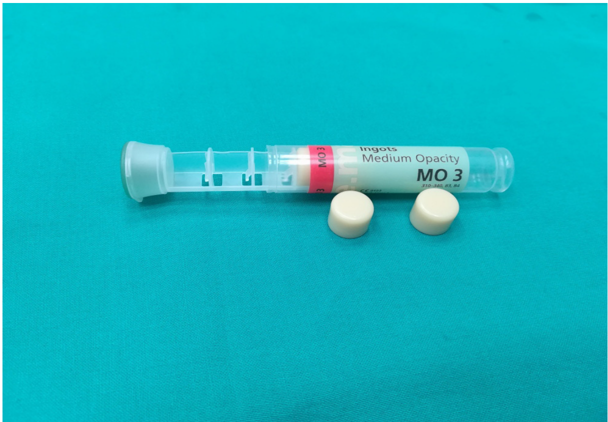
Slika 1. Keramički valjčići za vruće prešanje.
