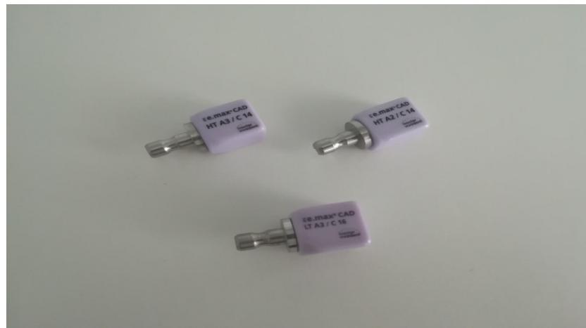
Slika 4. Keramički blokovi za CAD/CAM izradu (IPS e.max CAD).
