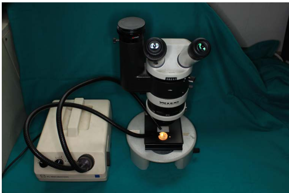
Slika 14. Određivanje količine zaostatnog cementa stereomikroskopom ( Wild Heerbrugg)
