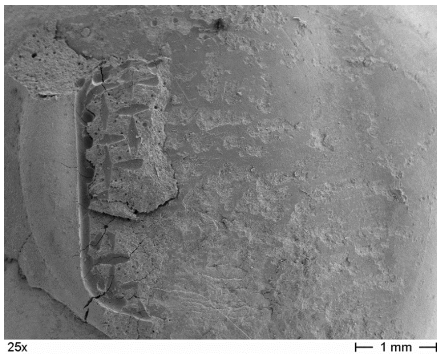
Slika 30. Površina cakline nakon uklanjanja bravice pod povećanjem od 25x u QSP skupini
