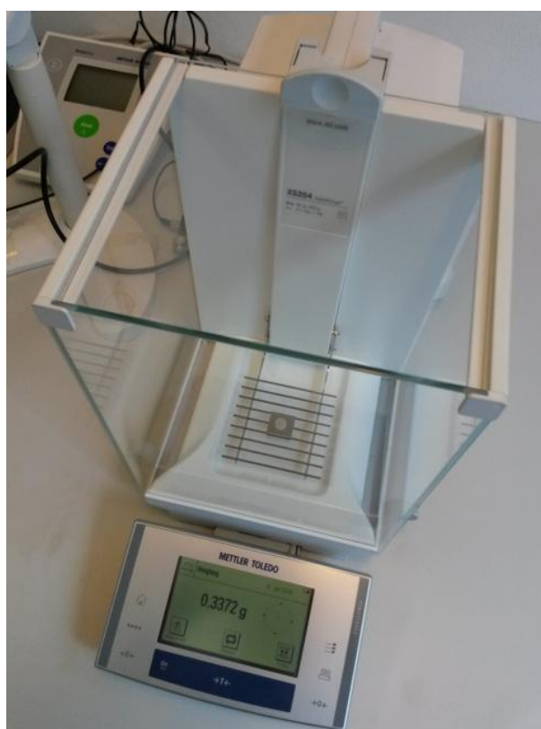
Slika 12. Analitička vaga s preciznošću mjerenja od 0,1 mg (XS204, Mettler Toledo)
