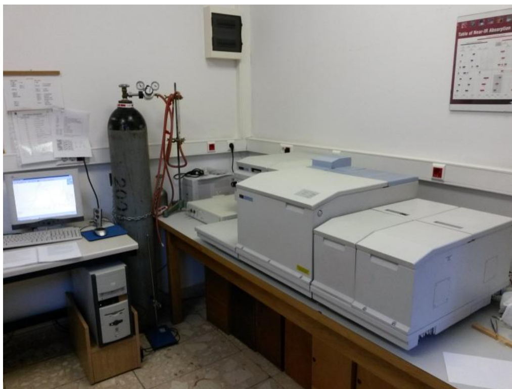
Slika 8. FT-Raman spektrometar Spectrum GX (PerkinElmer)
