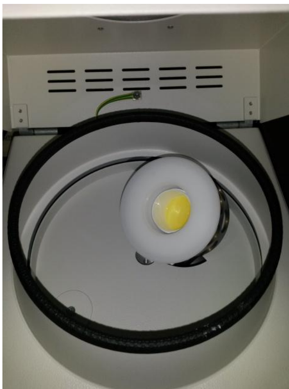
Slika 6. Pripremljena kompozitna pasta u rotoru miješalice. Intenzivna žuta boja potječe od kamforkinona
