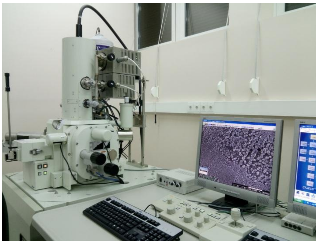
Slika 7. Rasterski elektronski mikroskop FE-SEM JSM 7000 (JEOL)
