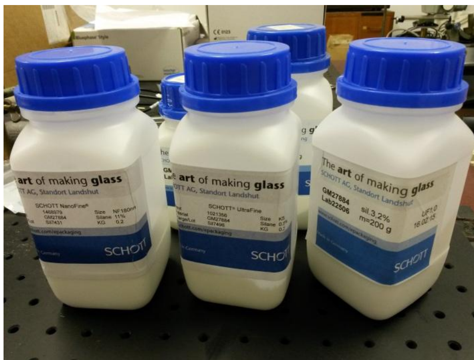
Slika 3. Tvornička pakiranja ojačavajućih punila od silaniziranog barijeva stakla
