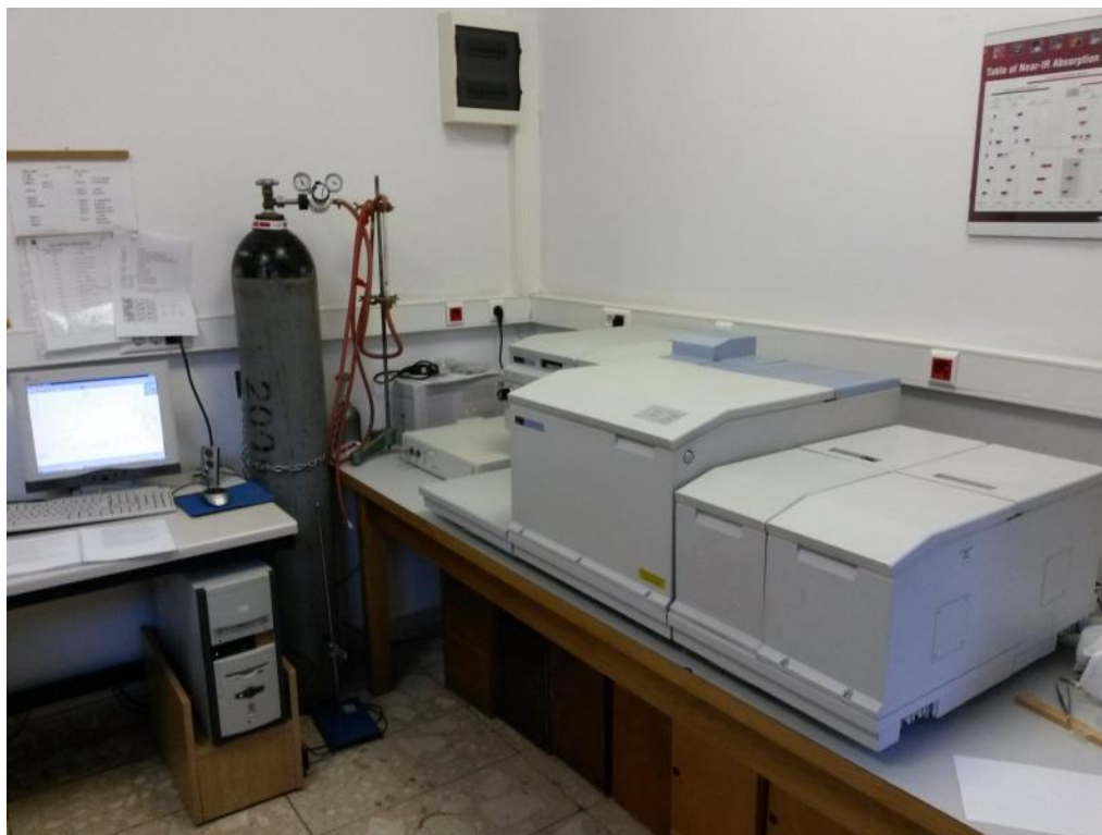
Slika 8. FT-Raman spektrometar Spectrum GX (PerkinElmer)
