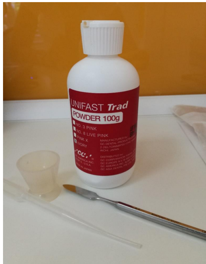
Slika 4. Unifast TRAD, GC Europe, MMA materijal za izradu privremenih nadomjestaka. Slika je izravni doprinos autora diplomskog rada.
