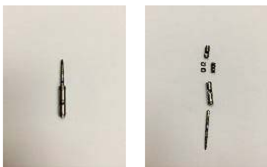
Slika 1. Dijelovi glave turbine. Preuzeto s dopuštenjem autorice prof. dr.sc. Ketij Mehulić
