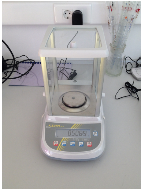
Slika 13. Određivanje mase uzorka na elektroničkoj analitičkoj vagi prije i poslije svakog perioda uranjanja.
