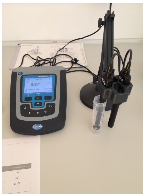
Slika 15. Određivanje pH vrijednosti ispitivane otopine pomoću pH-metra prije i nakon svakog perioda uranjanja.
