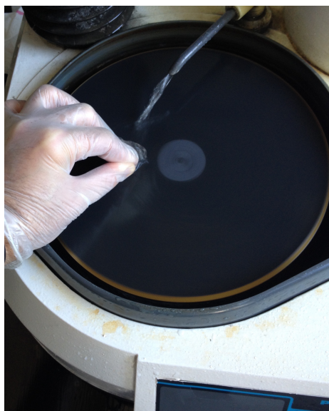
Slika 12 Poliranje uzoraka na stroju za poliranje Phoenix Alpha, “Buehler”, SAD pomoću SiC brusnog papira pod mlazom vode u Laboratoriju za materijalografiju, Fakulteta strojarstva i brodogradnje Sveučilišta u Zagrebu, Hrvatska.
