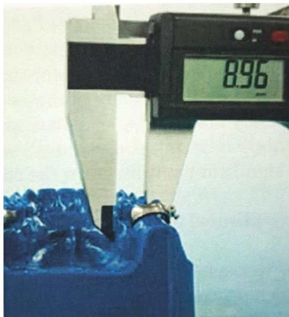
Slika 21. Određivanje debljine kosti u smjeru postavljanja mini implantata na modelu čeljusti. Preuzeto s dopuštenjem izdavača (7).
