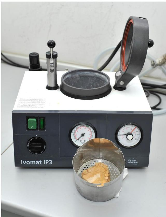
Slika 17. Uređaj za toplinsko tlačnu polimerizaciju akrilata
