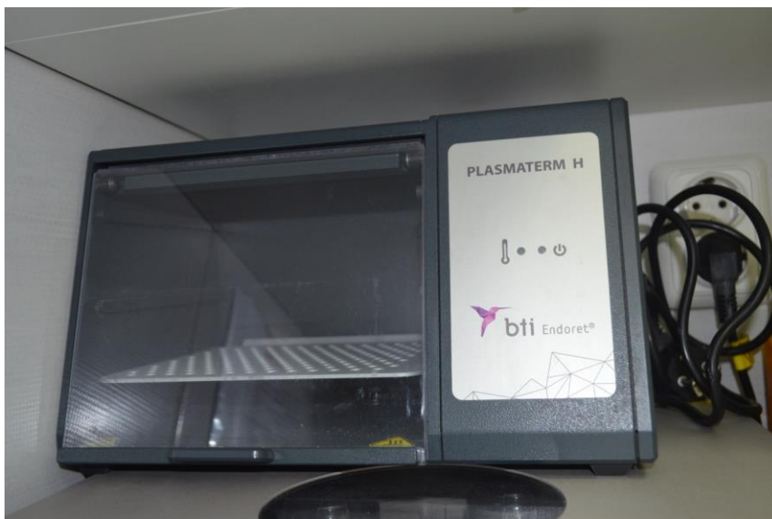
Slika 4. Stroj za dobivanje PRGF-a “ Plasmatherm H ” (ljubaznošću dr. Deana Cekića)
