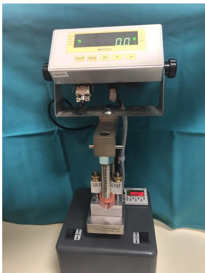
Slika 9. Uređaj za mjerenje jačine adhezijske sveze (UltraTester, Bond Strength Testing Machine, Ultradent Products, Inc., South Jordan, UT, USA)
