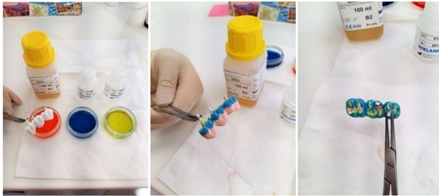
Slika 5. (a), (b) i (c) Infiltracijsko bojenje nesinteriranog mosta od cirkonij-oksidge mosta.
