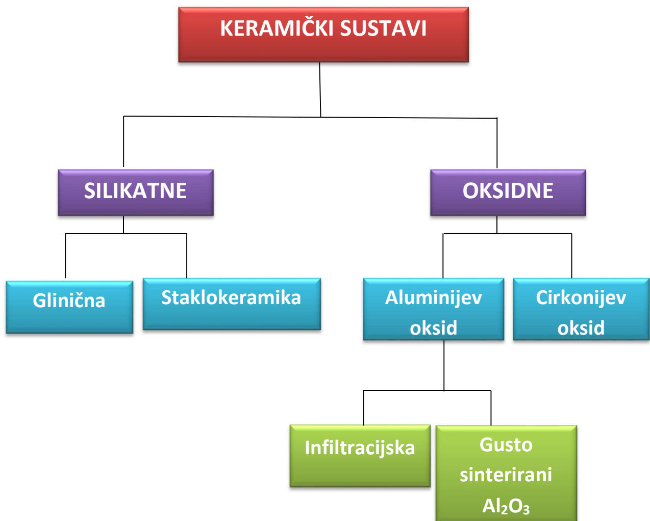
Slika 1. Jedna od najčešćih podjela keramičkih sustava prema kemijskom sastavu
